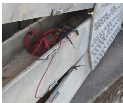
Figur 5.2 Töjningsgivare på luckben.
