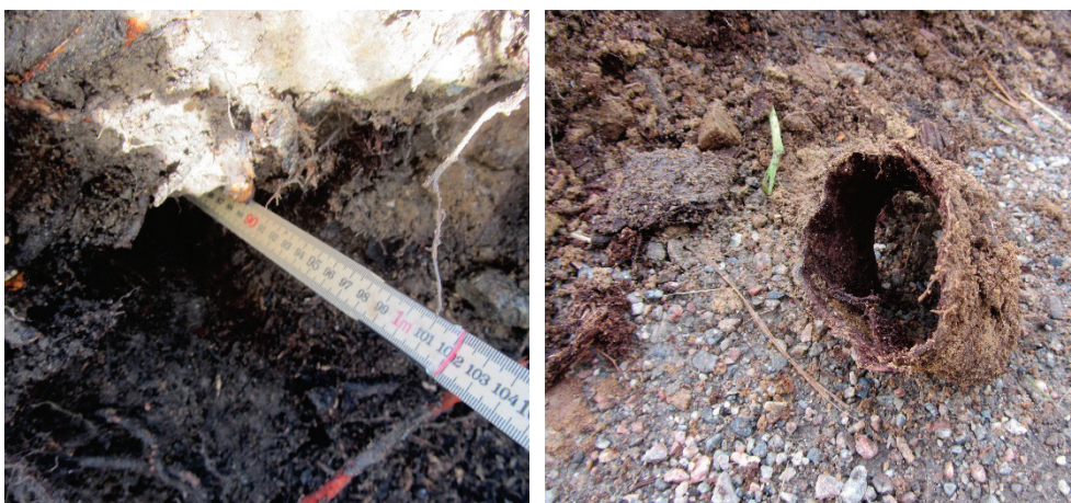
Figur 15 Håligheter efter totalt förmultnade rötter hittades under sättningen i Figur 14
