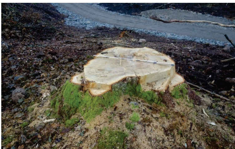
Figur 24 Ekstubbe med stamdiameter 110 cm precis nedströms dammtån
