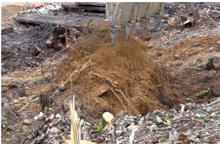
Figur 42 Rotsystemet till bokstubbe med stamdiameter 25 cm i nedströmsslänten
