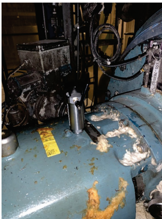
Figur 18. Trådlös vibrationssensor från SPM på en MC-pump i blekeriet på Södra Cell i Mönsterås.
