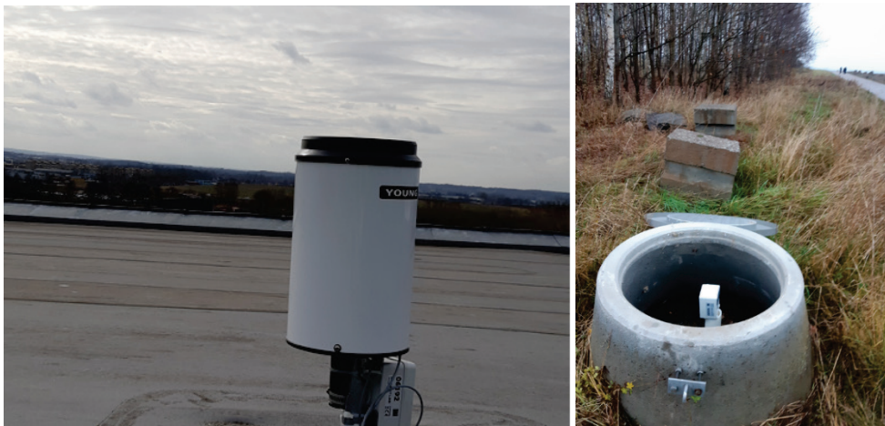
Figur 17. Regnmätare som sitter monterad på Rådhuset Skåne Kristianstad (vänster). Grundvattenmätare som sitter placerad i en provbrunn där kommunen tidigare lodat manuellt med 3-månaders intervall (höger). Foto: Magnus Lindgren.
