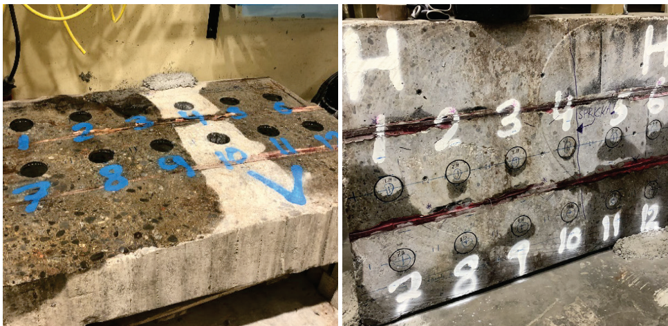
Figur 5.1 Provkroppar från Stenkullafors och placering av vertikala (VÅ) resp. horisontella (HÖ) kärnborrhål.
