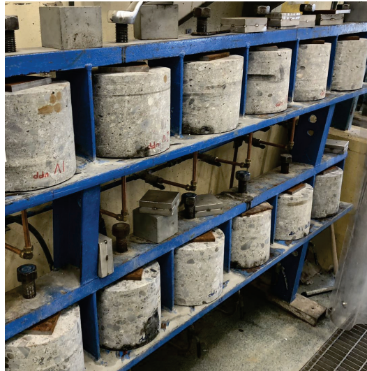
Figur 5.5 Test av vatteninträngning på överborrade kärnor (SS-EN 12390-8, 2019).
