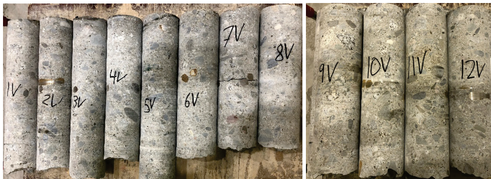
Figur 5.6 Urborrade kärnor från vertikala hål.
