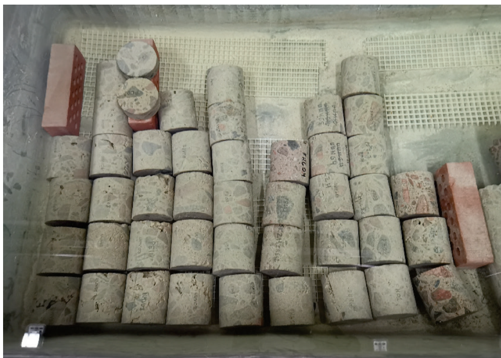
Figur 8. Utborrade cylindrar med diameter 100 mm sågade till längden 110 mm lagrade i vattenbad i väntan på provning av materialegenskaper.
