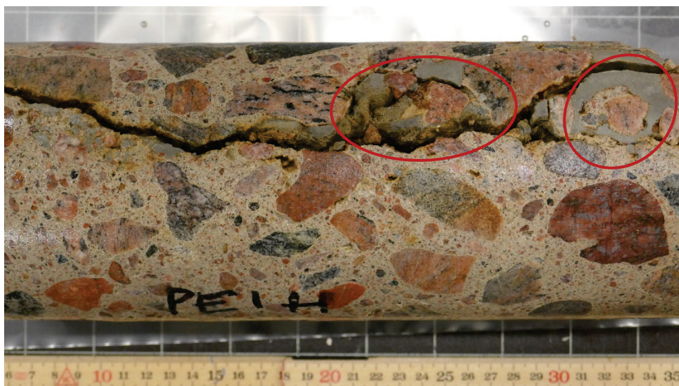
Figur 6. Borrkärna uttagen i horisontell riktning genom gjutfogens plan och den horisontella sprickan sammanfaller med gjutfogen. Invid delar av sprickan påträffades injekteringsbruk som har markerats med ringar.
