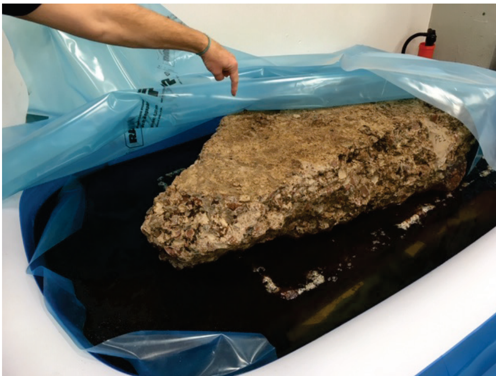
Figur 3. Efter rivningen av dammen lagrades de uttagna blocken på LTH delvis nedsänkta i vattenbad. För att förhindra uttorkning av betongen var vattenbaden täckta med plastfolie vilken säkerställde en lagringsmiljö med hög relativ fuktighet.
