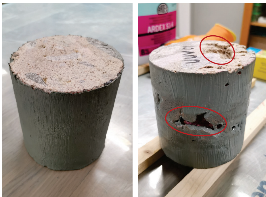
Figur 11. Provkroppar med förseglad mantelyta inför permeabilitetsmätning. Till vänster syns en frisk provkropp. Till höger syns provkroppen i Figur 10 med tydliga spår av urlakning, se markering med ringar.
