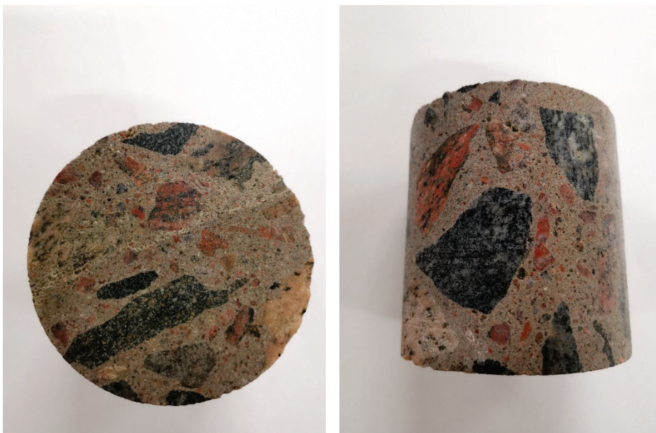
Figur 9. Provkropp utan visuella spår av urlakning, där fotografiet till vänster visar sågat snitt och fotografiet till höger mantelytan. Betongen sorterar under kategorin frisk provkropp.
