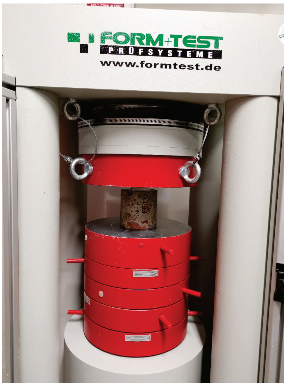
Figur 22. Betongcylinder monterad i provningsmaskin (ALPHA 3-3000 AD, Form+Test) inför provning av tryckhållfasthet.
