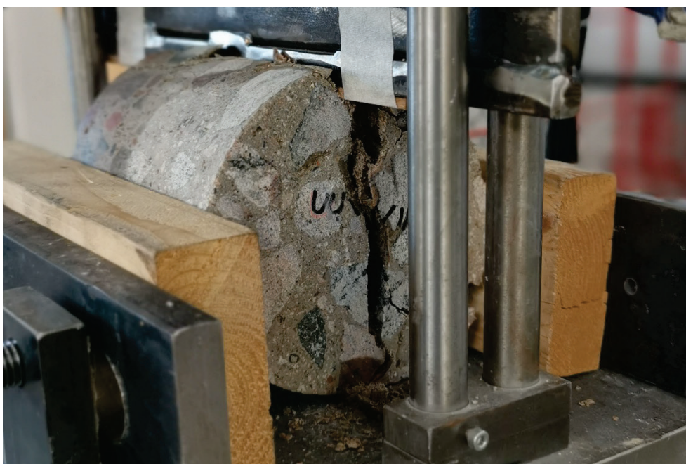
Figur 18. Betongcylinder med vertikal spricka efter genomfört spräckförsök.
