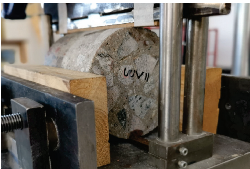
Figur 16. Prov monterat i rigg för mätning av spräckhållfasthet. En träfiberskiva med tjockleken 3 mm monterades i kontaktpunkterna mellan provkropp och spräckrigg för lastutjämning mot eventuella ojämnheter hos betongcylinderns mantelyta.
