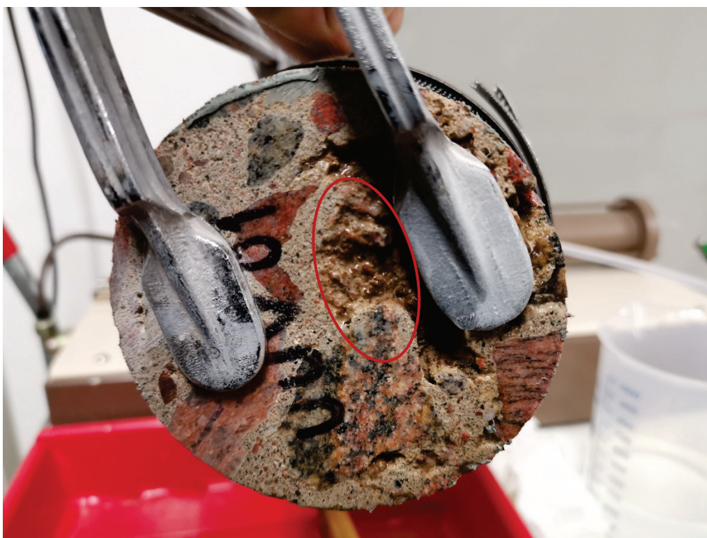
Figur 15. Utflöde av vatten på provkroppens undersida genom urlakat område markerat med ring.
