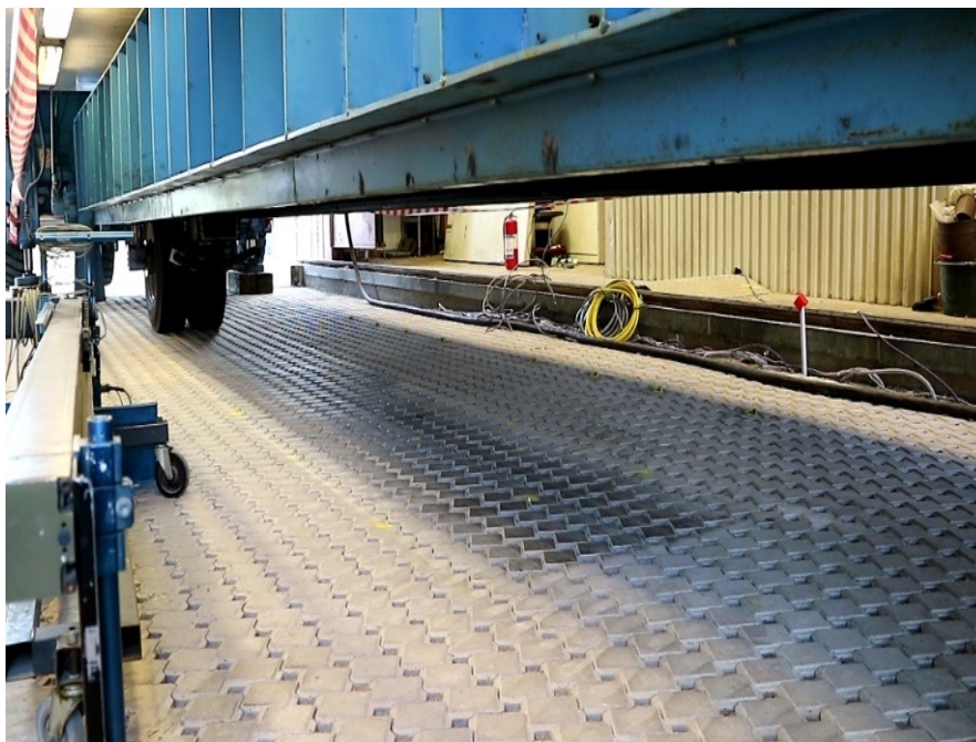
Provning av en livslängds belastning på 6 veckor
