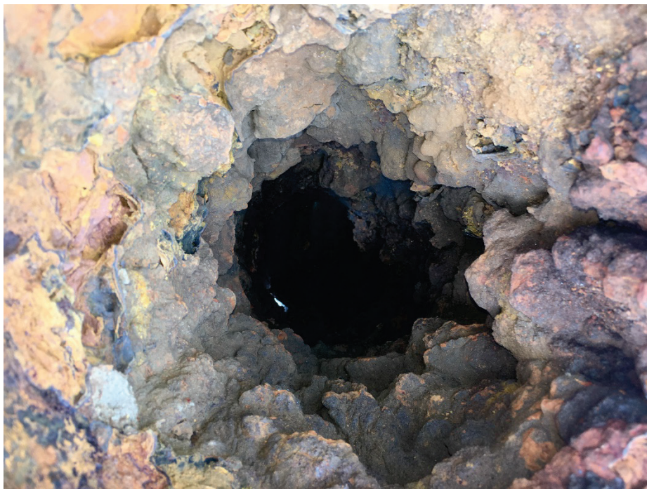
Figur 9. Tuberkler i dricksvattenledning anno 1875. Lyckligtvis en ovanlig företeelse i svenska fjärrvärmenät.
