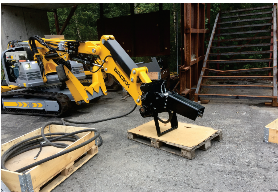
Figur 39. Brokk med utrustad med vattenspruta. 58
