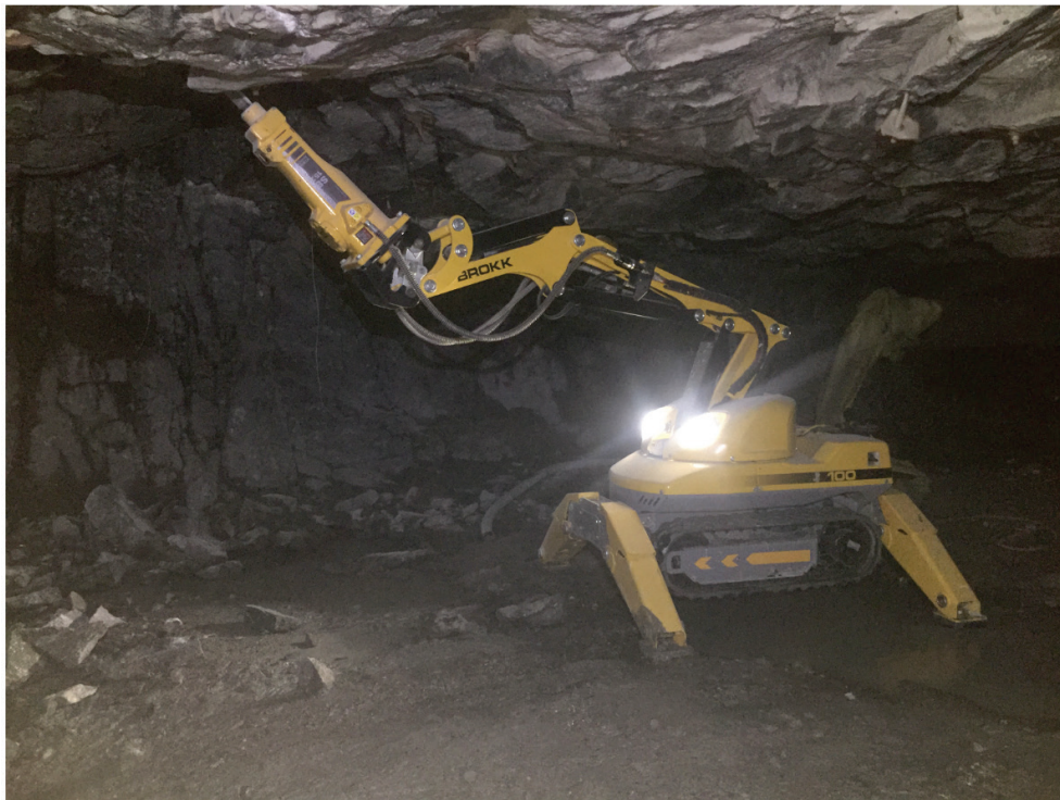
Figur 25. Brokk 110 i underjordsgruva på skrotningsuppdrag i Sydafrika. 39
