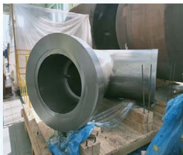
RPV主泵接管锻件
