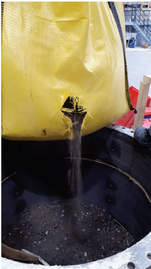
Figur 15. Finkornigt jordmaterial från storsäck töms i permeameter. Storsäcken lyfts med travers.
