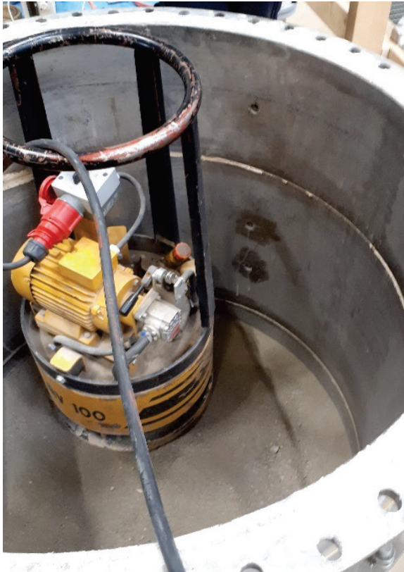
Figur 16. Packning av 0/16 jordmaterial i permeameter med padda.
