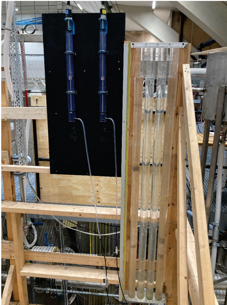
Figur 12. Mätrör för avläsning av tryckskillnader över provet. Uttag för slangar inkopplade till mätrören visas i Figur 13.
