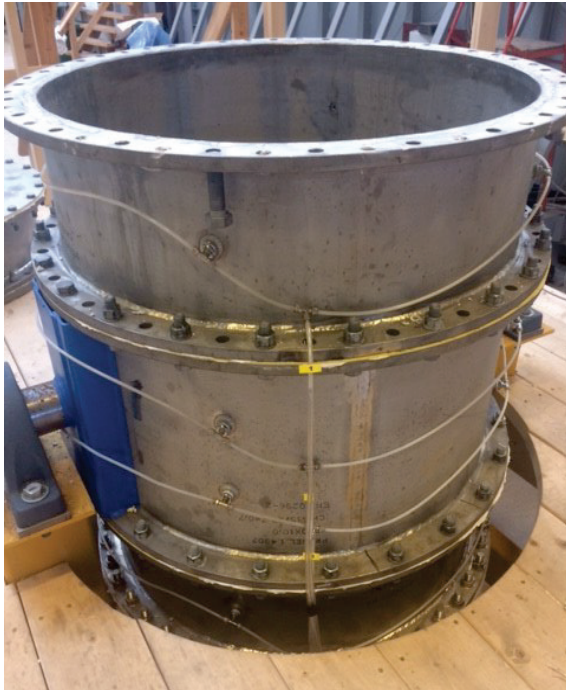
Figur 13. Installerade slangar för mätning av vattentryck på fyra olika nivåer i permeameter. Slangarna är kopplade till mätrör enligt Figur 12.
