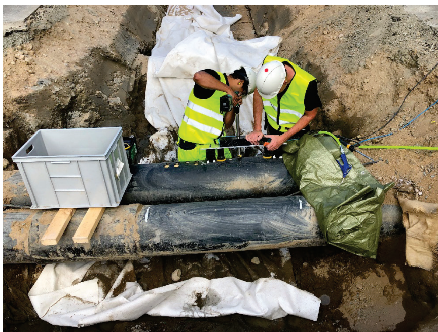
Figur 2: Provberedning i fält för RISE pluggmetod
