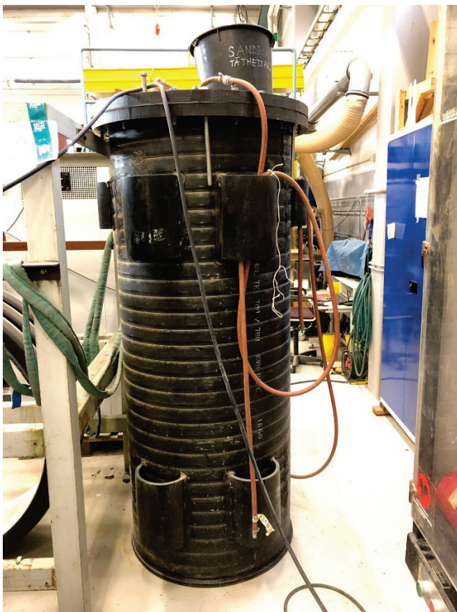
Figur 6: Tank avsedd för täthetsprovning av fjärrvärmeskarvar
