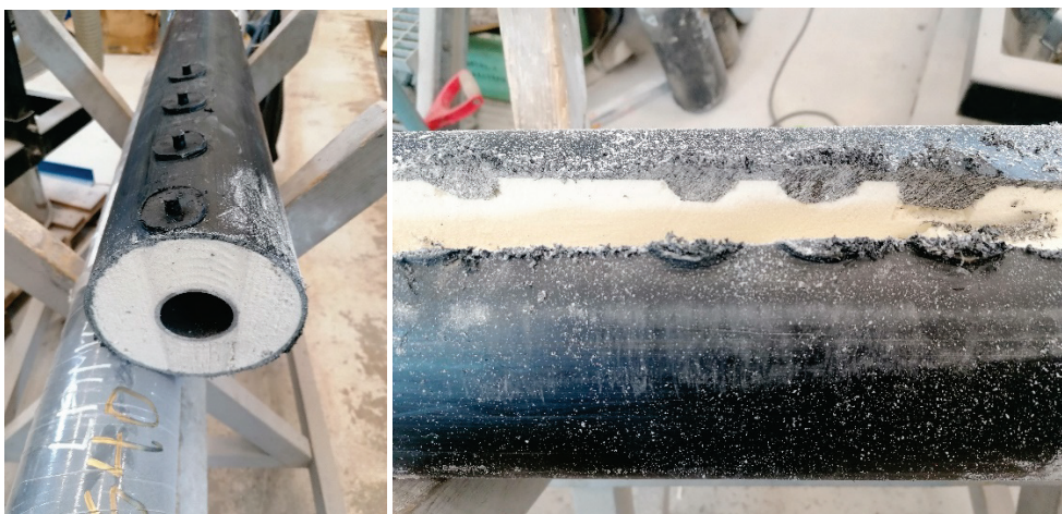
Figur 7: Efter nedsänkning i vatten sågades röret sönder för att se om något vatten trängt in
