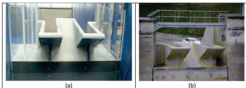
Figur 4.10 Pianotangentutskov vid Escouloubre-dammen, EDF – triangulära nosar under uppströmsöverhäng (Epicum et al. 2013). (a) modell (foto HECE-ULiege) och (b) prototyp (foto EDF).
