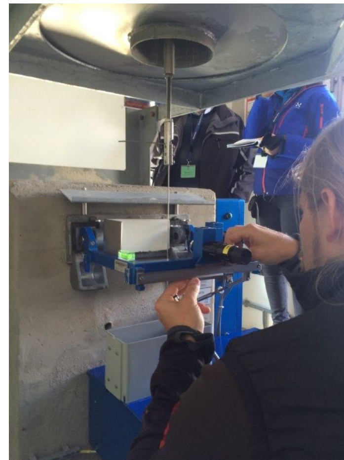
Kontroll av pendel mot fingerad förskjutning
