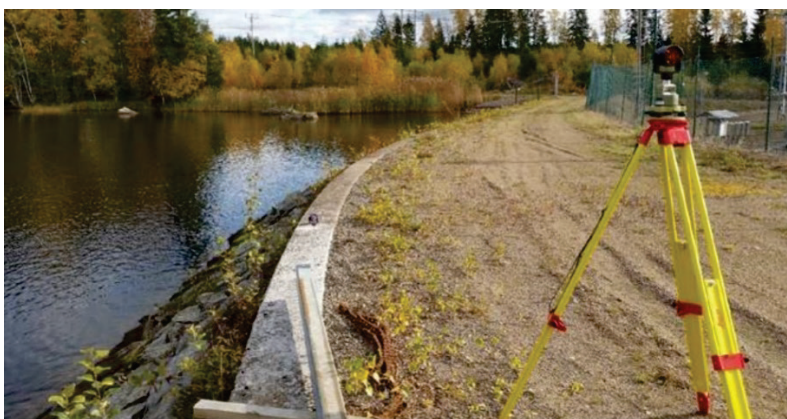
Figur 3- 5 Ett prisma på stativ – en objektpunkt för inmätning med totalstation.
