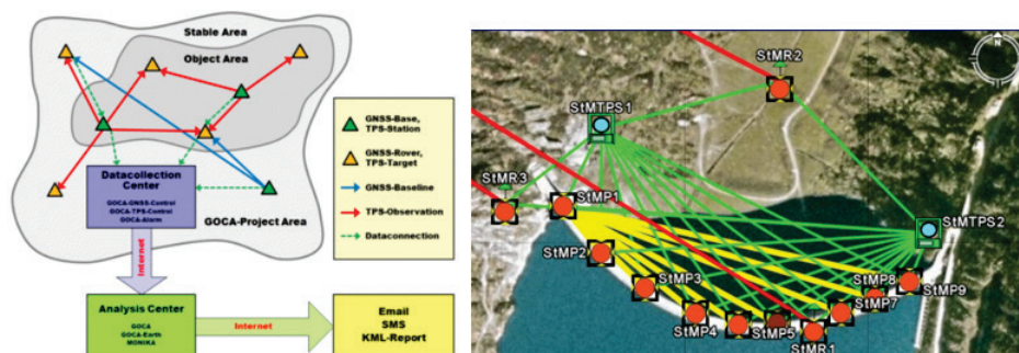
Figur 3- 7 Till vänster: principen för deformationsövervakning med GOCA. TPS står för "total station positioning system". Till höger: ett exempel på systemetableringen på en damm. Källa: http://goca.info .
