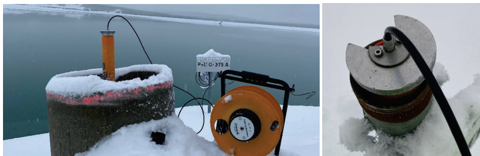
Figur 3- 21 Manuell inklinometerutrustning med sond, avläsningsenhet (handdator) samt lock vid rörmynningen för att fixera varje mätpunkt.
