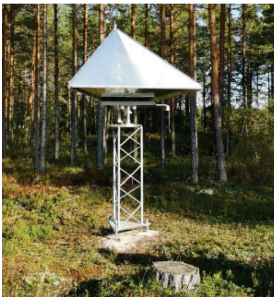
Figur 3- 18 En vinkelreflektor för InSAR installerad i Mårtsbo, Gävleborgs län. Fotograf: F. Nilfouroushan, Högskolan i Gävle.
