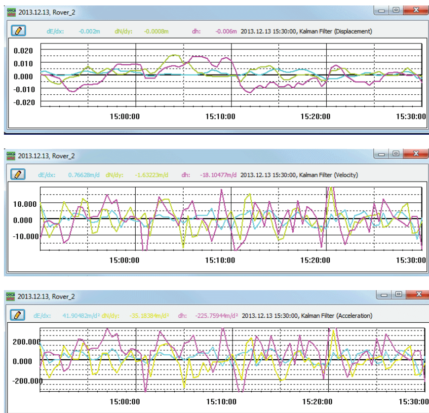
Figur 3- 9 Exempel på resultatet av deformationsövervakning med GOCA. Från topp till botten: beräknad rörelse, hastighet och acceleration i en objekt punkt. Källa: http://goca.info .
