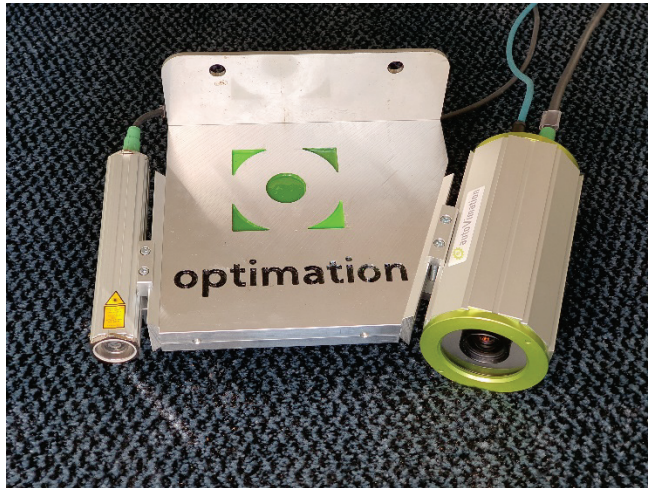
Figur 7. Mät huvud från 3DPM bestående av kamera och laser
