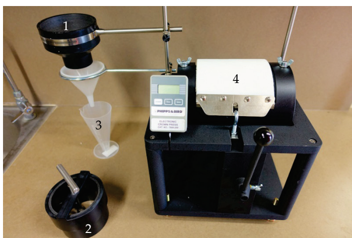
Figur 5 Bandpress i labskala. Instrumentet består av 1) behållare med ett filter i botten, där en första separation sker, 2) insats med handtag som driver roterande arm, vilken placeras i behållare 1 för ytterligare separation, 3) bägare där rejekt från separation i 1 och 2 samlas upp och läses av, 4) filterdukar där slammgen från 1+2 placeras, för att sedan i ett sista steg pressas mot den kupade ytan.
