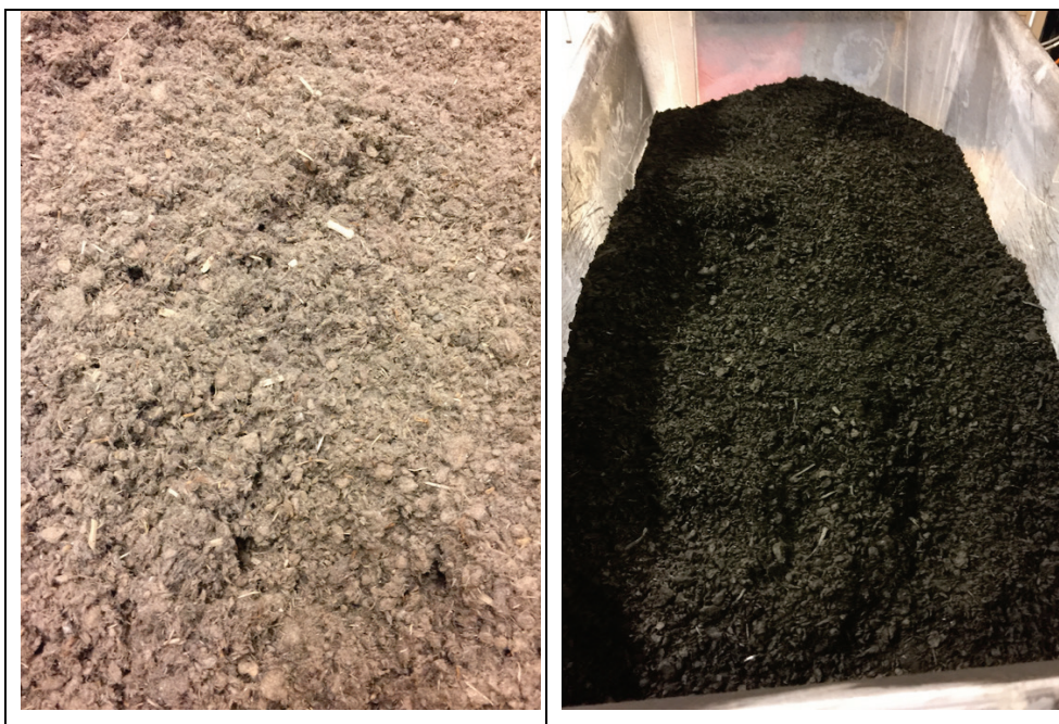
Figur 3: Blandslam före och efter pyrolysis.
