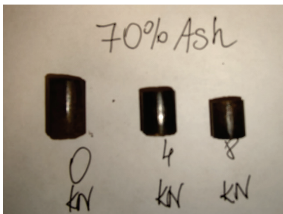
Figur 11: Pellets tillverkade av bibränsleaska och hydrokol i förhållandet 70:30. Ju högre tryck pelleten är pressad med, desto kortare pellets.
