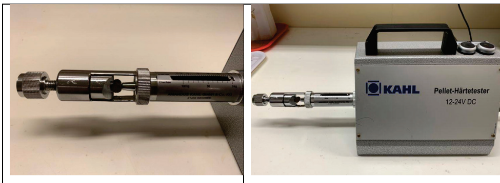
Figur 7: Trycket som behövs för att pressa sönder en pellets mäts med Kahl hårdhetstest.
