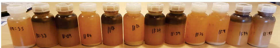
Figur 2. Förprov av spjälkvätska. Prover med svart ligninfas är uttagna vid pumpning från ligninfälla, övriga från botten av HDS.
