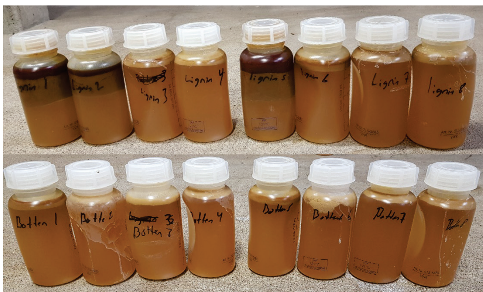
Figur 3. Huvudprov av spjälkvätska, där de översta 8 proverna är ligninfraktion (från ligninfällan) och de understa 8 proverna är bottenfraktion.
