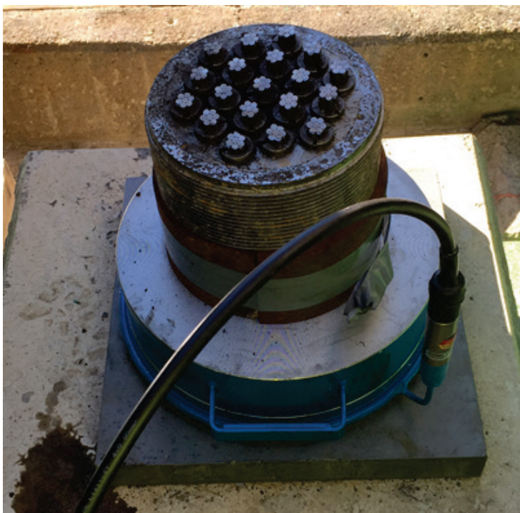
Figur 5-1. Lastcell monterad mellan ankarstycke och ankarplatta.
