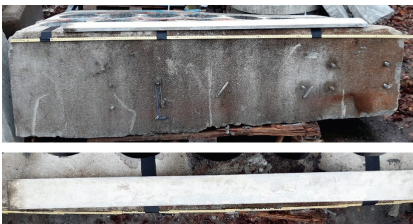
Figur 2.8. I den övre bilden ser man att ytan är relativt slät och den nedre bilden visar betongblocket ovanifrån. En tydlig kurvatur kan uppfattas.
