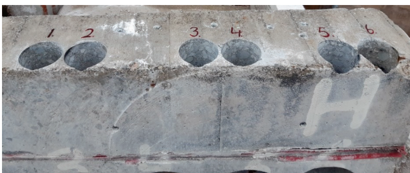
Figur 2.10. Urborrning av kärnor från skibordets underkant. Kärnor 1, 3 och 5 används till plan- och tunnslip, vattenabsorption samt kemiska analys. Kärnor 2, 4 och 6 används till vatteninträngning.
