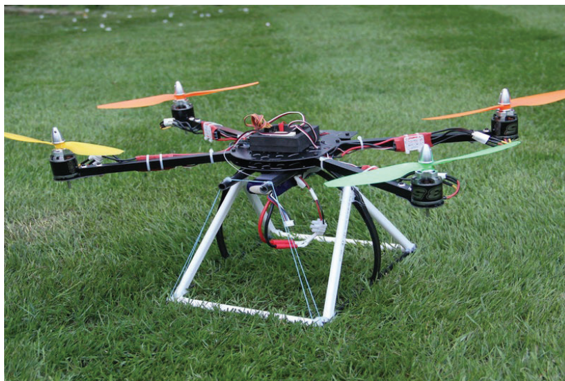
Figur 1. Quadcopter – Exempel på multikopter med fyra propellrar
