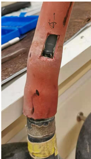
Bild 25. Avslut som uppvisat PD
