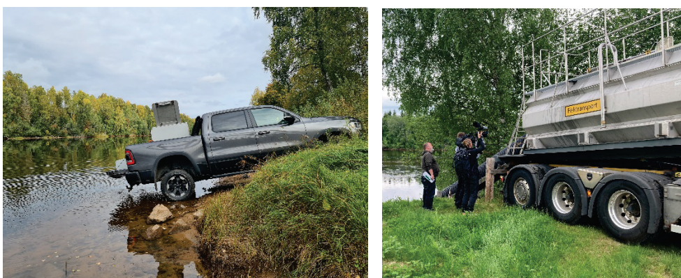
Figur 3 och 4. Fiskutsättning med liten transportbehållare (t.v.) och specialbyggd större transporttank (t.h.). För att undvika fysisk hantering av fisken i samband med utsättningen (t.ex. hävning) släpps fisken från transporttank via en portabel utsättningsränna (t.v.) respektive ett permanent monterat rör ner till vattnet (t.h.). Fotograf Johnny Norrgård (t.v.) och Marco Blixt (t.h.).
