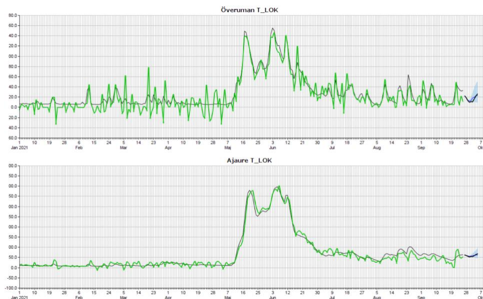
Figur 19. Två exempel från Vattenregleringsföretagens dataportal ( https://login.vattenreglering.se/vhi/ ) som visar beräknade observerade (grå) och modellerade (grön) lokaltillrinningar för de två magasinerna högst upp i Umeälven för 2021. Längst till höger syns prognosen (blå) för utvecklingen de kommande dyggen.
