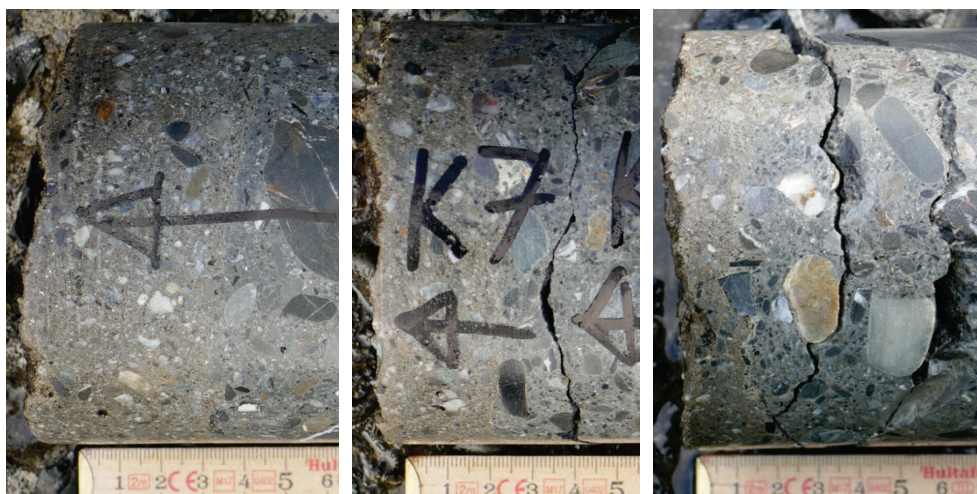
Figur 45. Kattstrupeforsen. Utskov 2. Tre betongkärnor utan (t.v.) respektive brott i konstruktionsbetongen.
