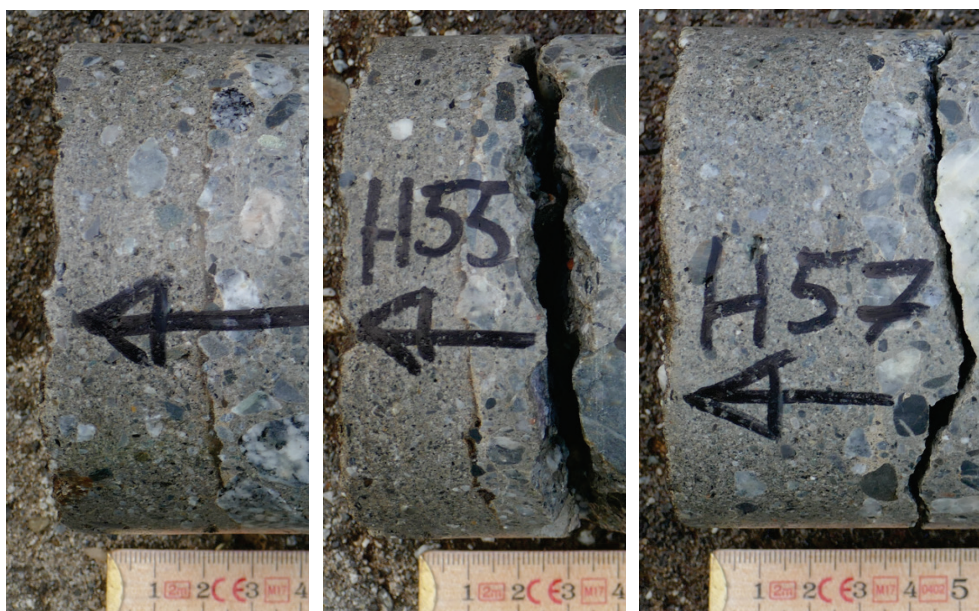
Figur 27. Hissmofors. Utskov 5. I betongkärnorna kan en ljusbrun rand noteras vid läget för vidhäftningszonen. I betongkärnorna H55 och H57 inträffade brottet mellan 5 och 10 mm under vidhäftningszonen.
