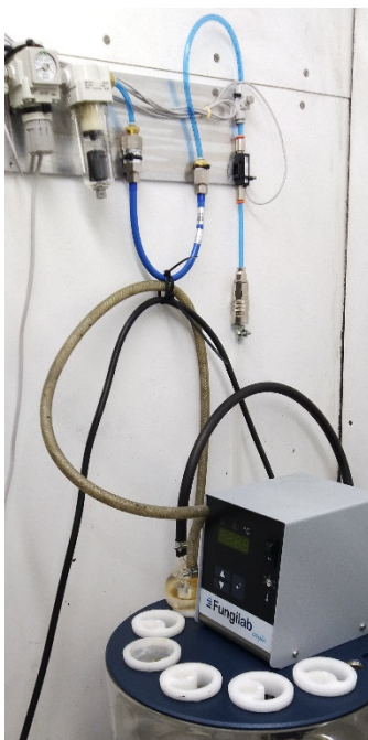
Figur 2. Försökuppställning för åldring av glycerol. Torr luft tillförs kontinuerligt till 200 ml glycerol vid en förhöjd temperatur.
