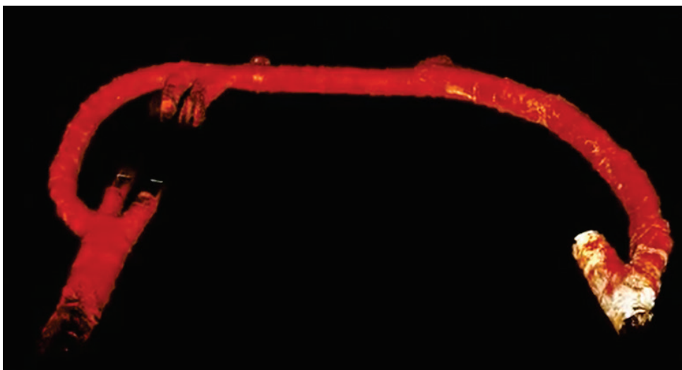
Figur 3-9 Svalltunnel och uppströmsdelen av utloppstunneln, animering av skanning utförd med drönare (AMKVO i samarbete med Scior Geomanagement och Ängelholms Geodesi).
