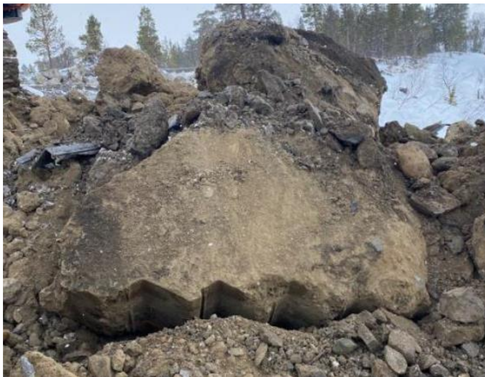
Figur 3.1 Tjälblock intill sponten, med ungefär en meters mäktighet.
