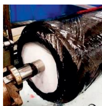
Fiberlindning av tank
