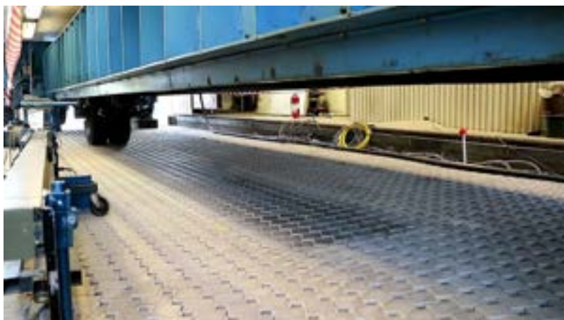
Figur 2. Provningshall med pågående provning av permeabla konstruktioner
