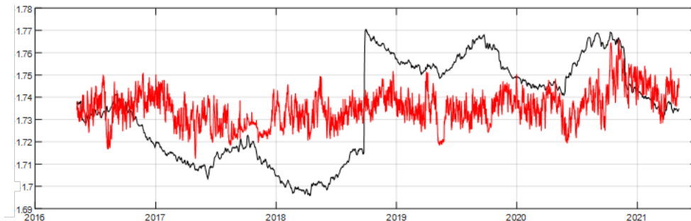
Figur 39. Predikterad (röd) från modellen PLS4 och observerad signal (svart) för S.D001.S09.T32 som är ett grundvattenrör. Modellen har en prediktionsförmåga Q2 på -0.134 vilket kan ses som tecken på en undermålig modell.
