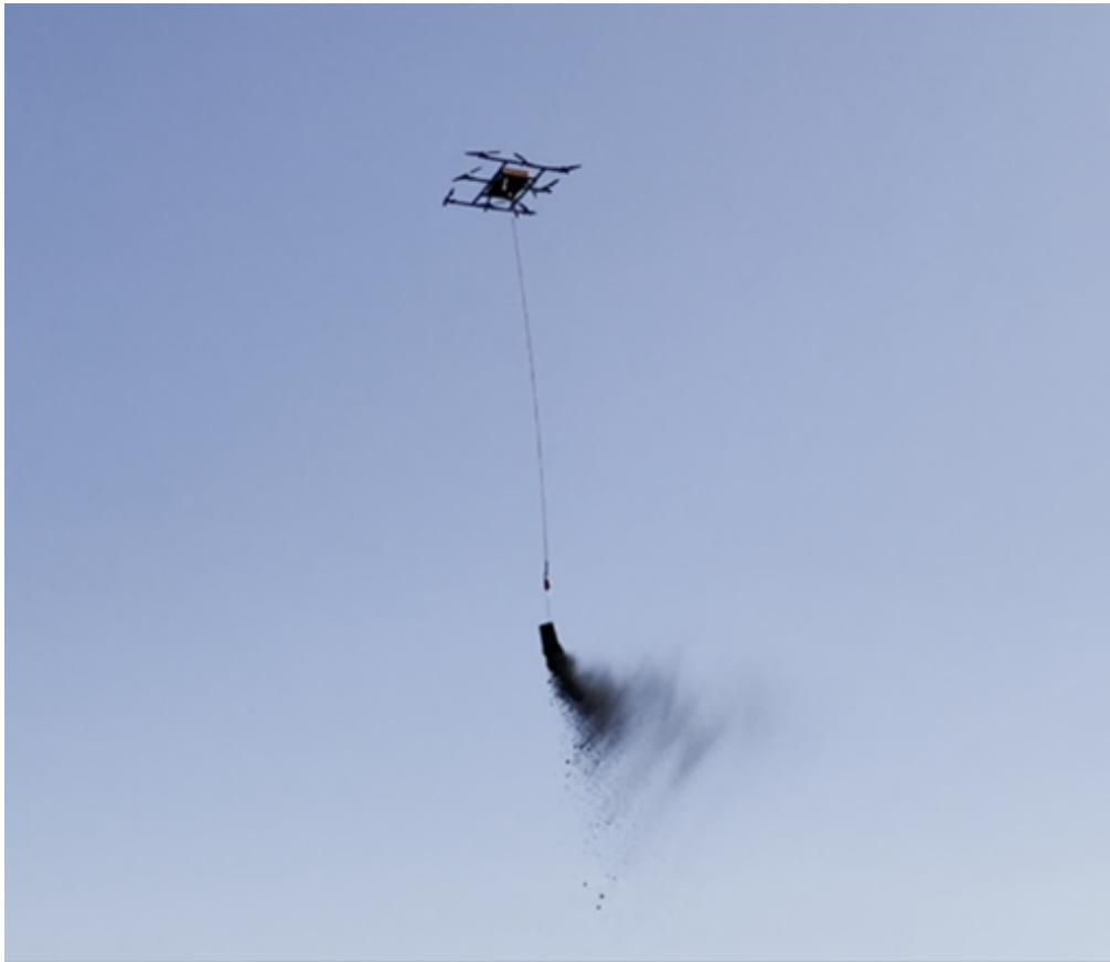
Bild 4. Flygprov med Proto8 och spridningstunna med 30 kg krossaska.
