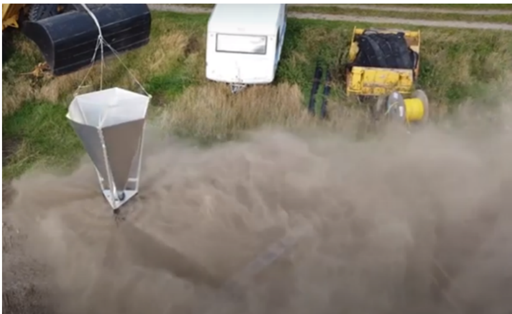
Bild 2. Statiska prov utomhus, provhöjd 10 – 35 m.
