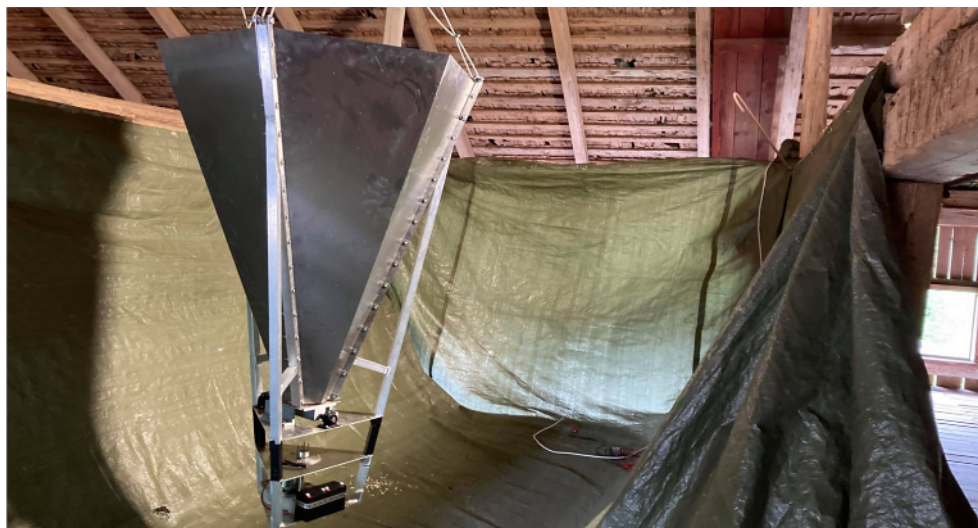
Bild 1. Prov av fullstor spridare i testhall, provhöjd ca. 3m
