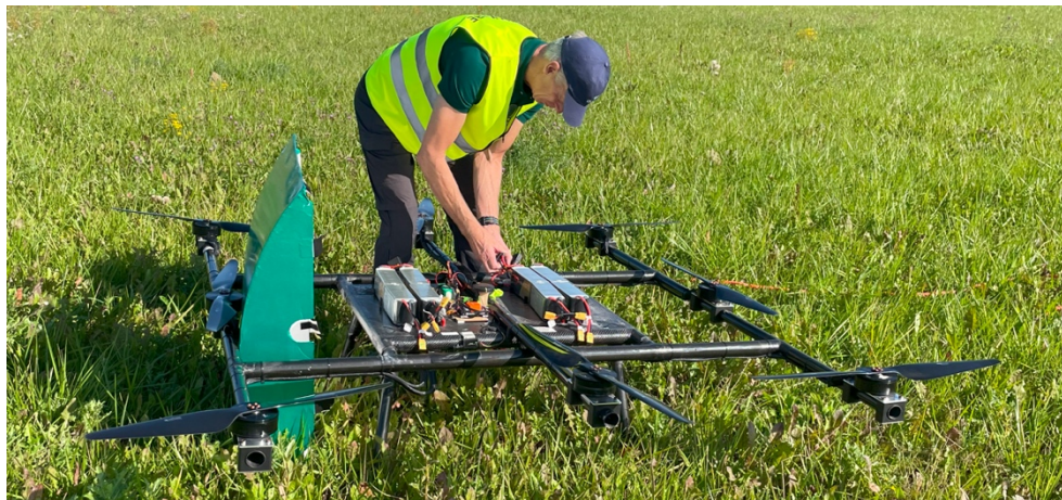
Bild 3. Multikopter Proto8 med 8 motorer och en lyftförmåga på 80 kg.
