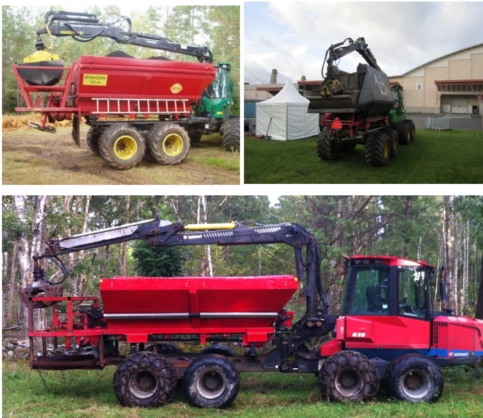
Figur 3 Överhäng bak maskin med varierande skydd kring spridningstillrikarna
