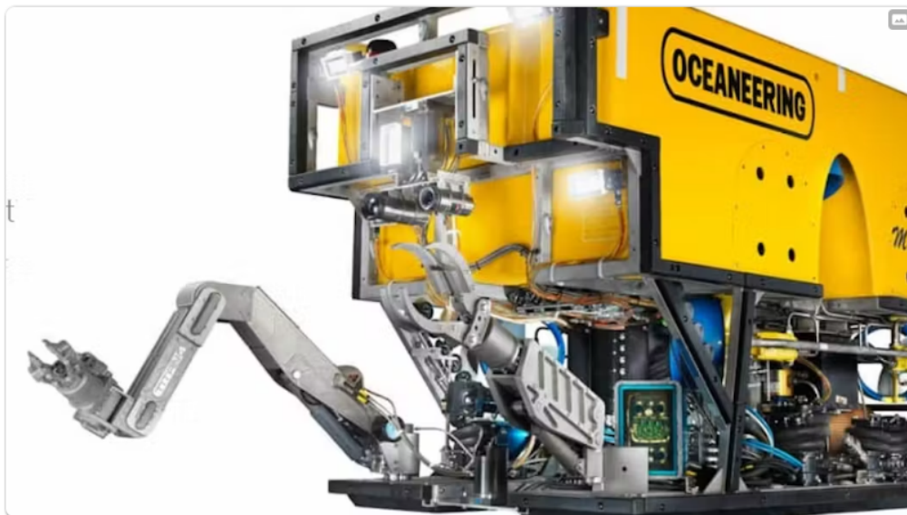
Figur 2-3 En stor modell av WROV, Oceaneering Magnus Plus 4
