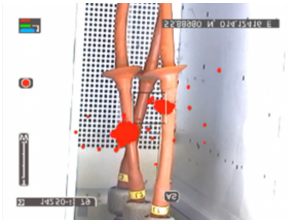
Figur 2. Den komponent som uppvisar allvarligast fel är ändavslut
