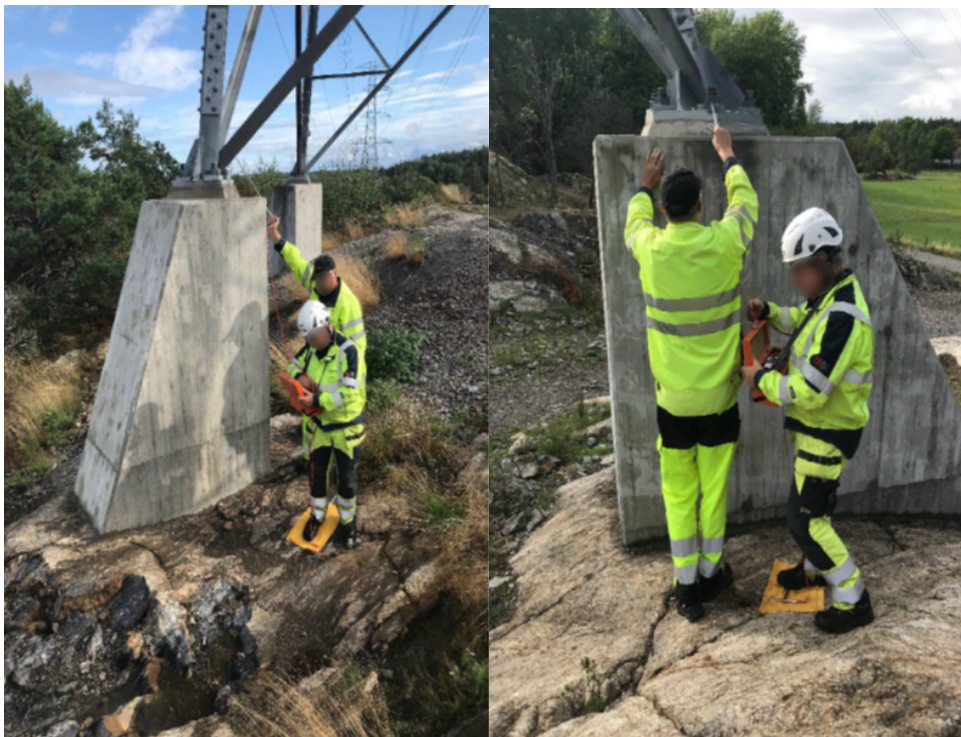
Figur L.1 – Exempel på bestämningen av impedansen till jord genom starkströmsmetoden
