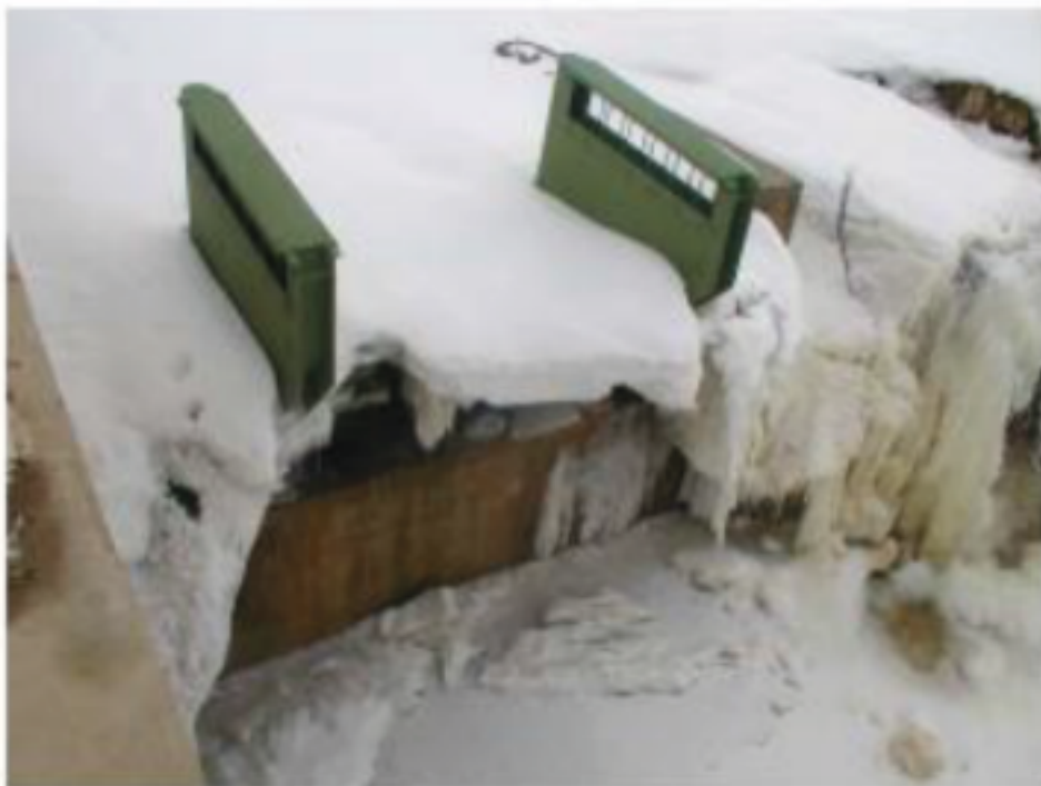
Figur 3.8 I situation vid fuse gate-strukturen under fältförsök 2001–2002 (Hydroplus 2010, Chapuis 2018, Kocahan and Rodionov 2003).
