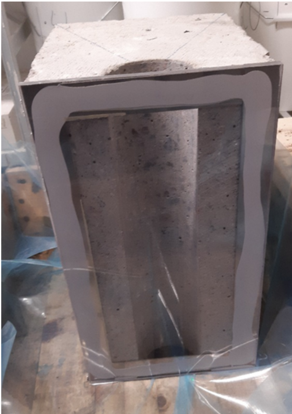
Figur 2.9. Betongblock med urborrad kanal och plexiglasskiva med en 2 mm spalt mot betongyrorna innanför plexiglasen.
