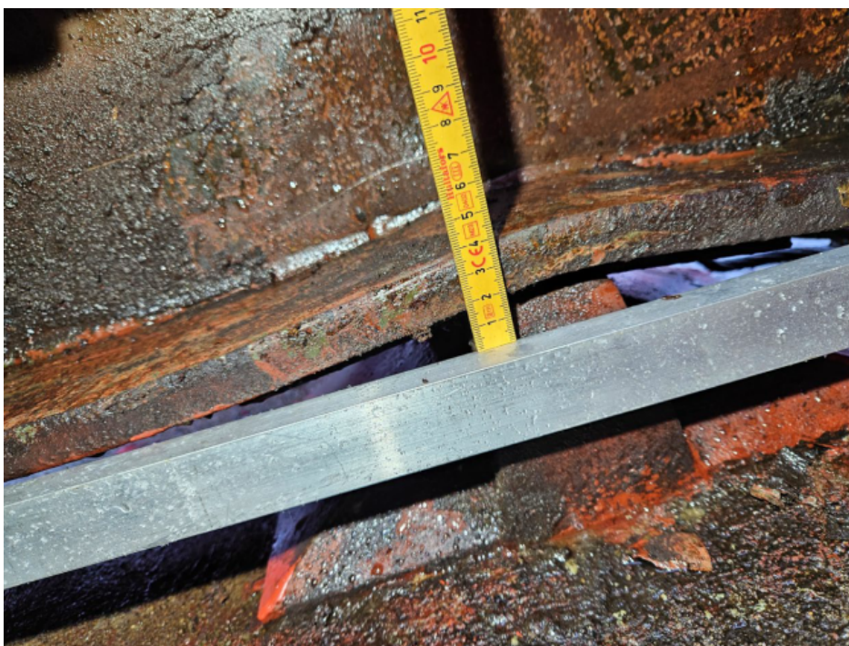
Figur 9-59 Spelstativet har tryckts ihop ca. 20 mm pga. den stora belastningen.
