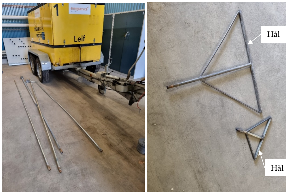
Figur 9-10. Till vänster visas exempel på ångaggregat som kan köras med personbil och på golvet ligger lansar. Till höger visas exempel på munstycken som konstruerats för att kunna skruvas på lansarna. Dessa har hål med jämna mellanrum som släpper ut ångan som flödar genom rören.
