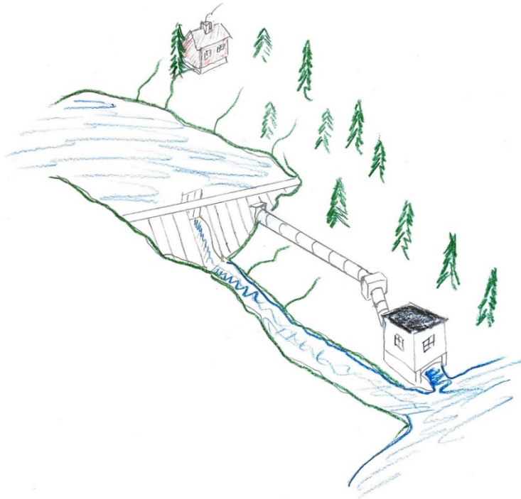
Figur 6-1. Principskiss för exemplet, en mindre kraftverksdamm med kraftstation dämler upp ett magasin i kuperad terräng med ett bostadshus nära släntkrönet ned mot magasinet.
