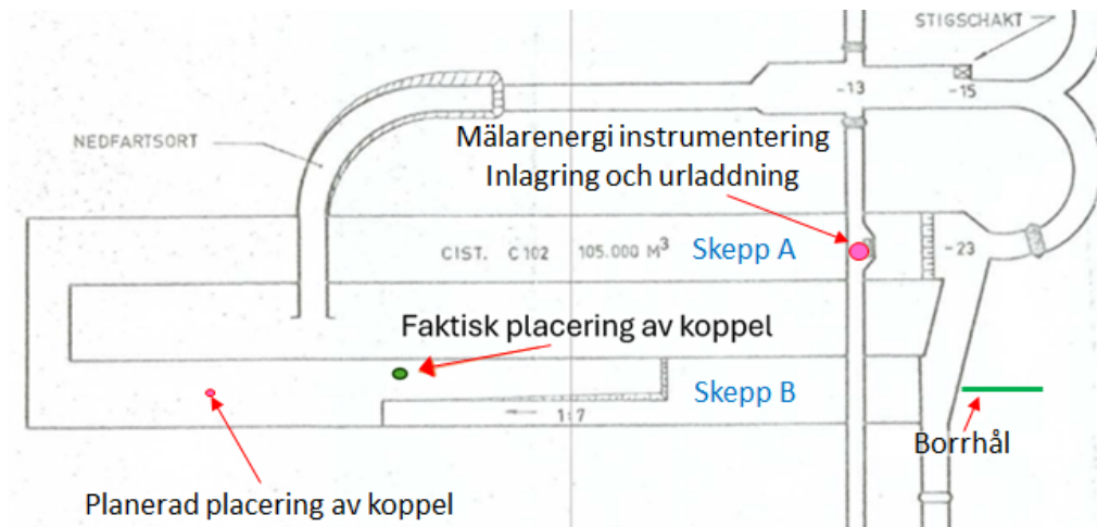
Figur 57 Faktisk respektive planerad placering av mätkoppel i vattnet.
