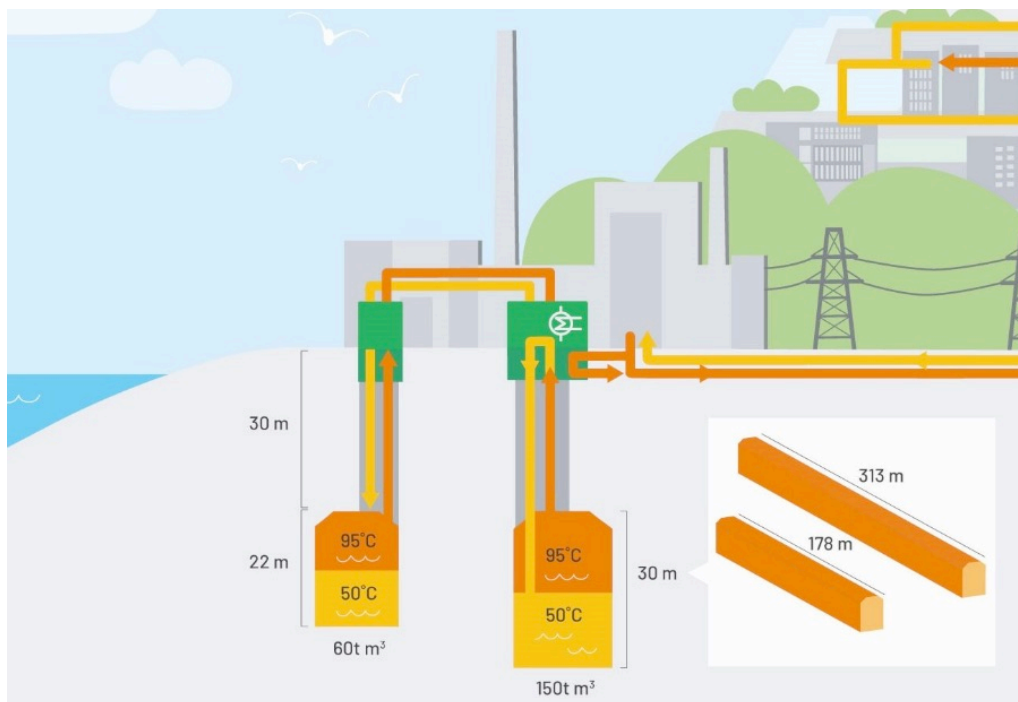
Figur 16 Värmelagret i Vasklot, Vasa. Vänstra bergrummet har volymen 60 000 m 3 och högra 150 000 m 3 . 22
