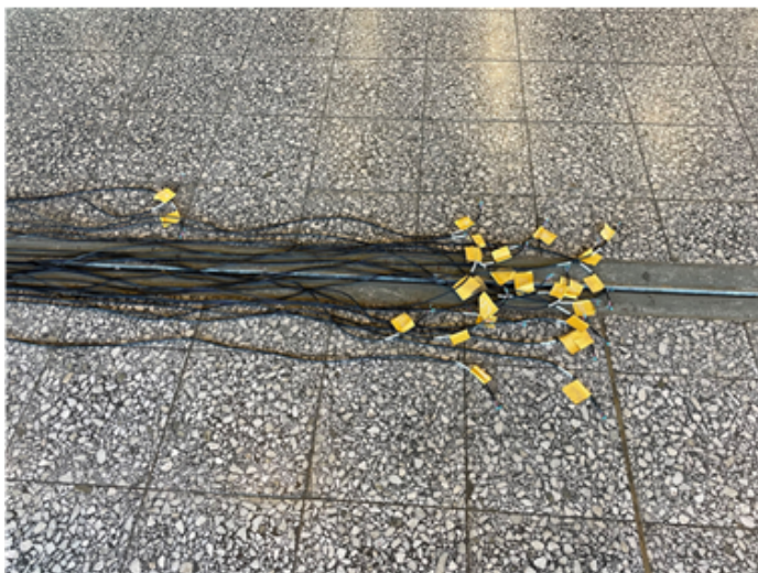
Figur 49 Givarkoppel till temperaturmätning i bergumslagret.
