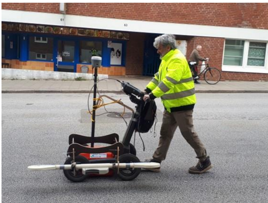
Figur 3. Mätningar utförda med georadarteknik (foto Öresundskraft)
