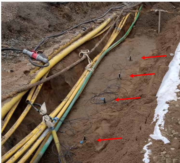
Figur 7. Mätning av jordresistivitet med Wenners 4-pinmetod (Furutorpsgatan)(foto, 3C AB)
