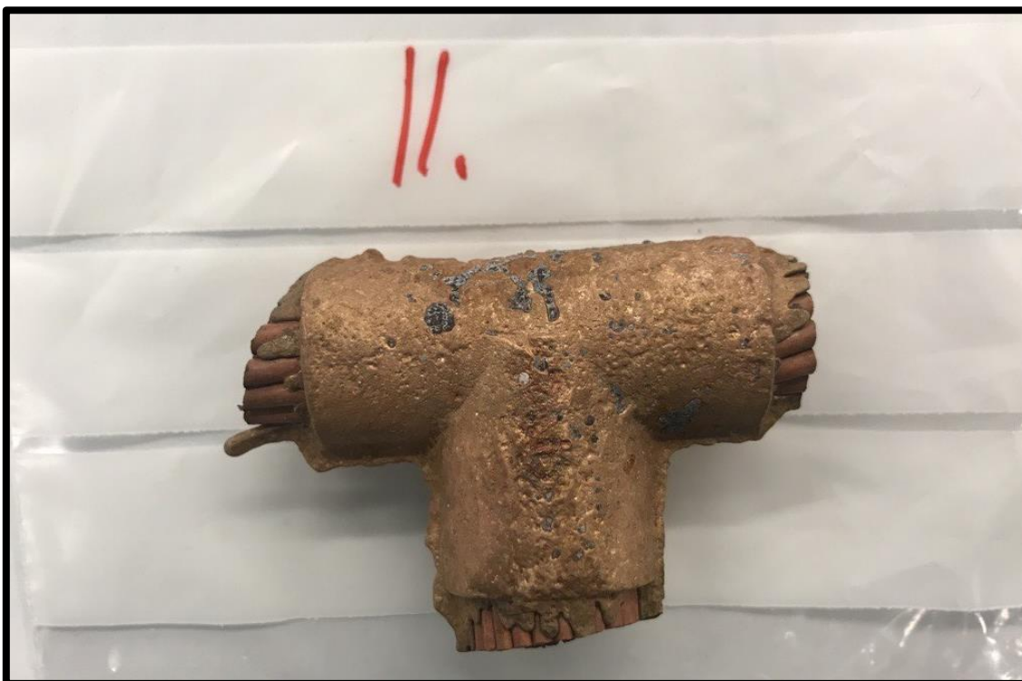
Figur 58: Klämma från prov 11 efter betning, framsida.
