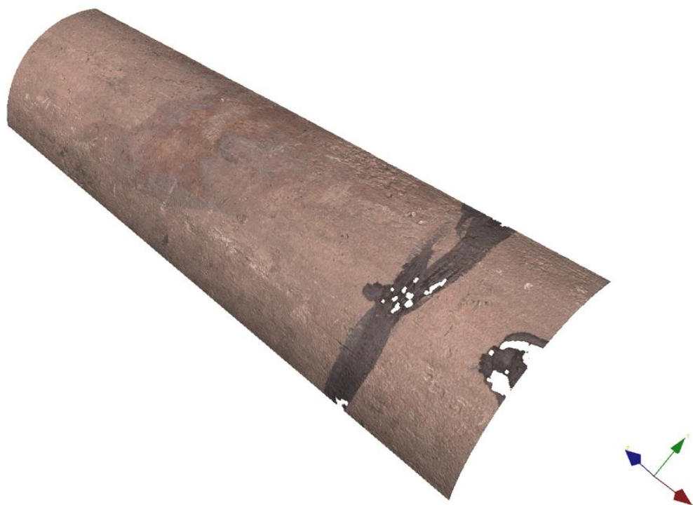
Figur 73: Prov 4 – Yttre kardel (del 1). Gropdjup 16 mikrometer.
