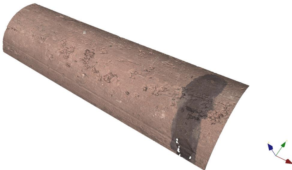
Figur 86: Prov 8 – Yttre kardel (del 2). Gropdjup 67 mikrometer.
