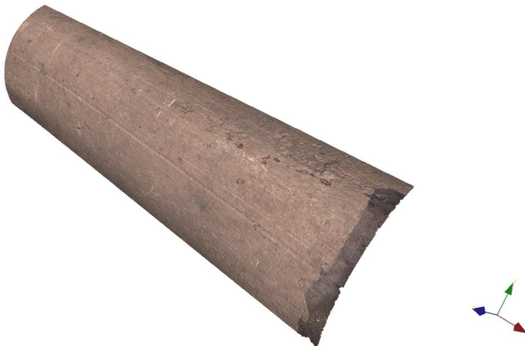
Figur 94: Prov 12 – Inre kardel. Groddjup 46 mikrometer.
