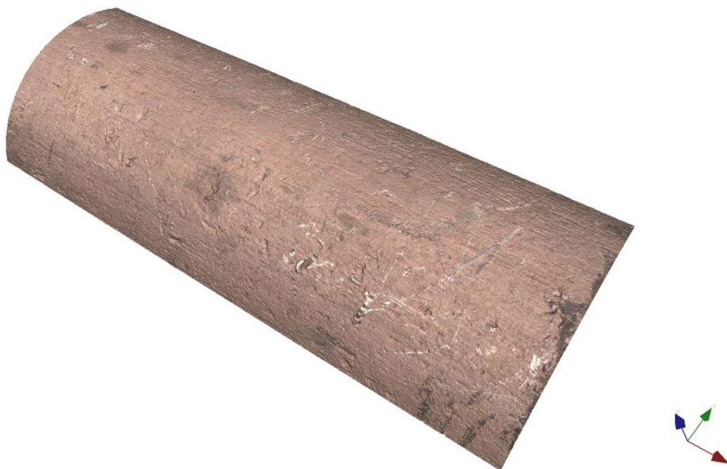
Figur 93: Prov 11 – Yttre kardel (del 2). Groddjup 1-2 mikrometer.
