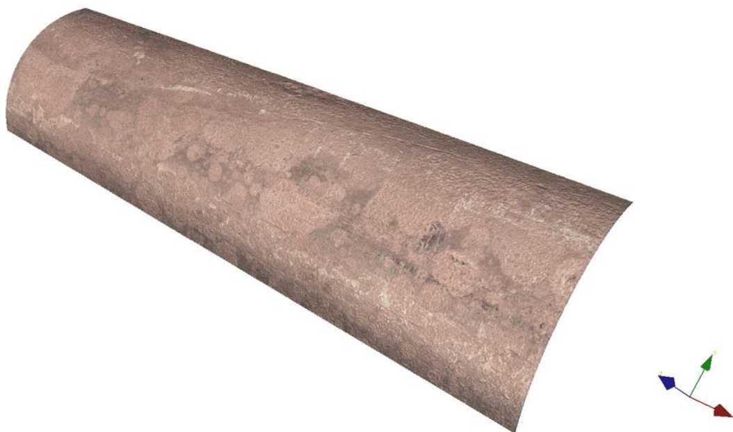
Figur 72: Prov 4 – Inre kardel. Gropdjup 5 mikrometer.
