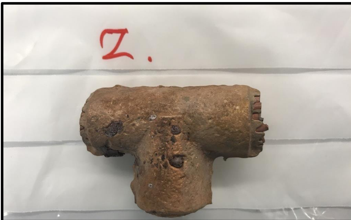
Figur 49: Klämma från prov 2 efter betning, baksida.
