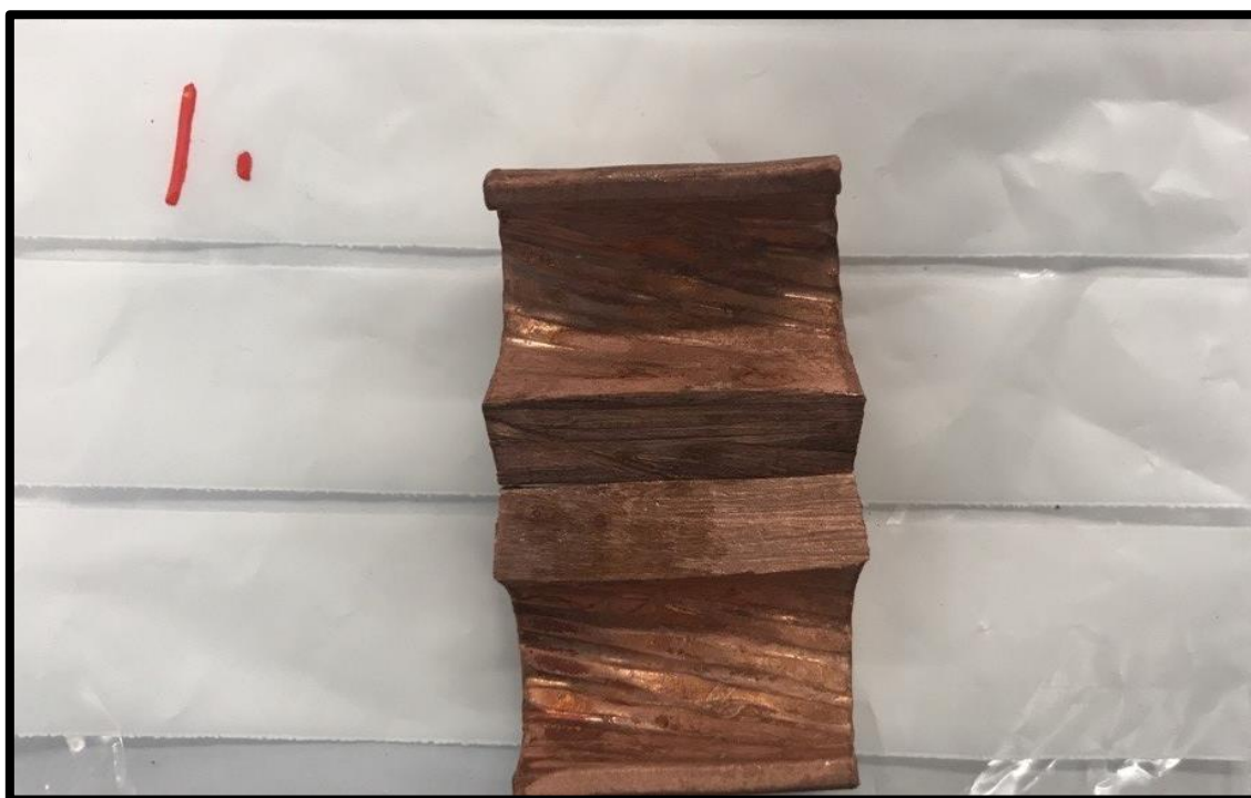
Figur 46: Klämma från prov 1 efter betning, insida.
