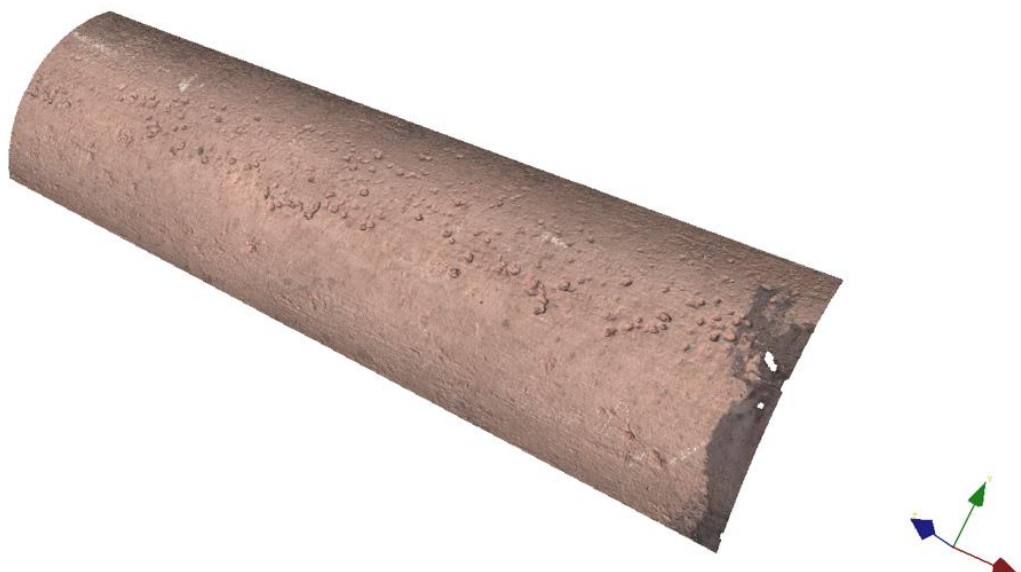
Figur 85: Prov 8 – Yttre kardel (del 1). Gropdjup 32 mikrometer.
