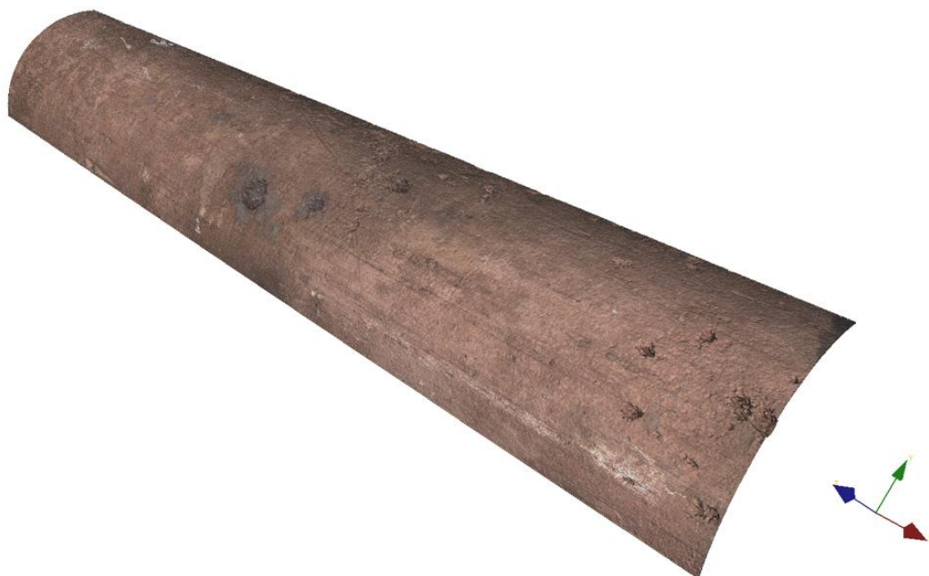
Figur 70: Prov 2 – Yttre kardel (del 1). Gropdjup 141 mikrometer.
