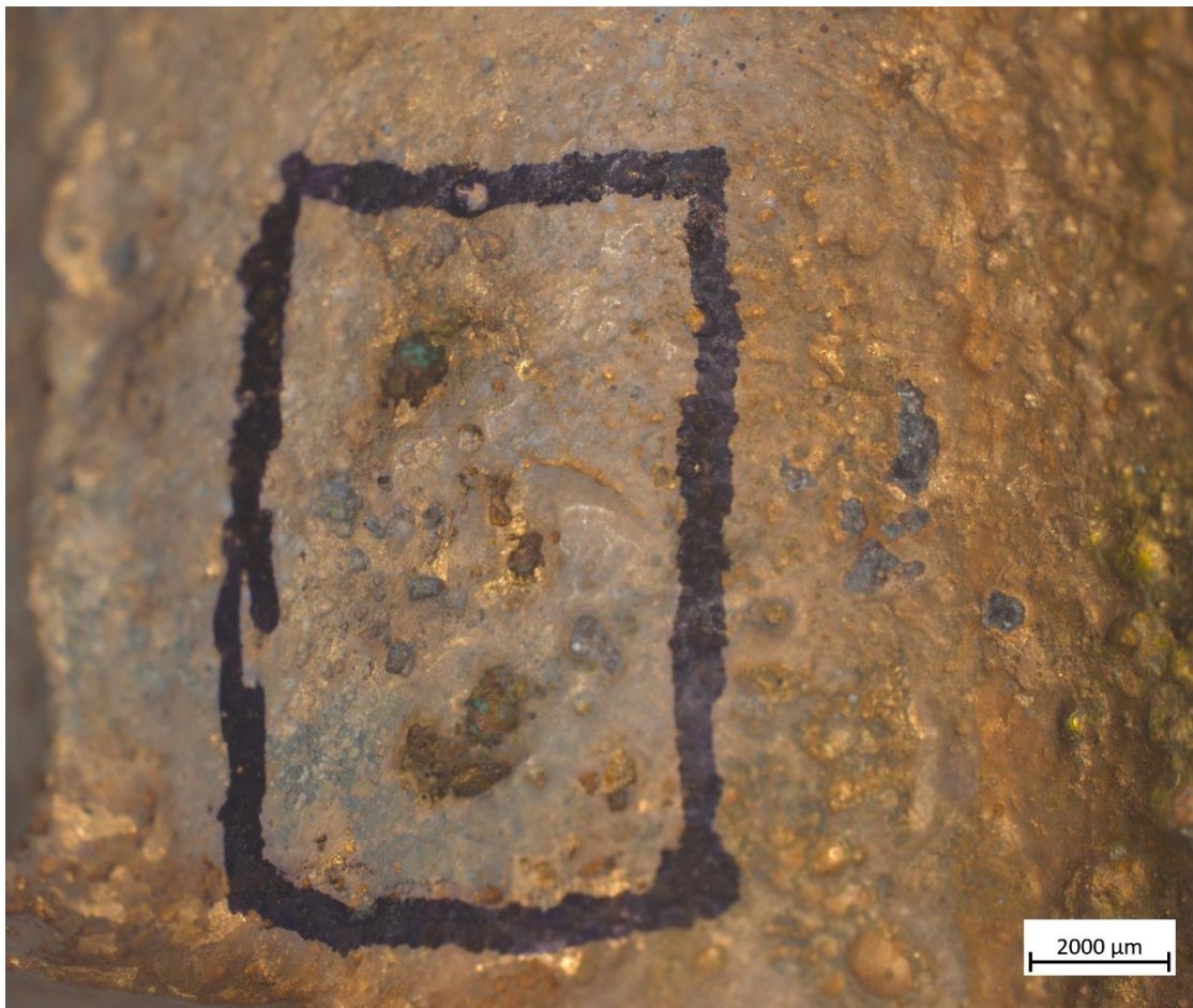
Figur 97: Prov 12 – Klämma. Gropdjup ca 900 mikrometer. På grund av geometrin (fysiskt begränsning under mikroskopsobjektivet i Alicona InfiniteFocusSL) kunde mätningar endast göras i Zeiss Axio Zoom med förstoring 56x.
