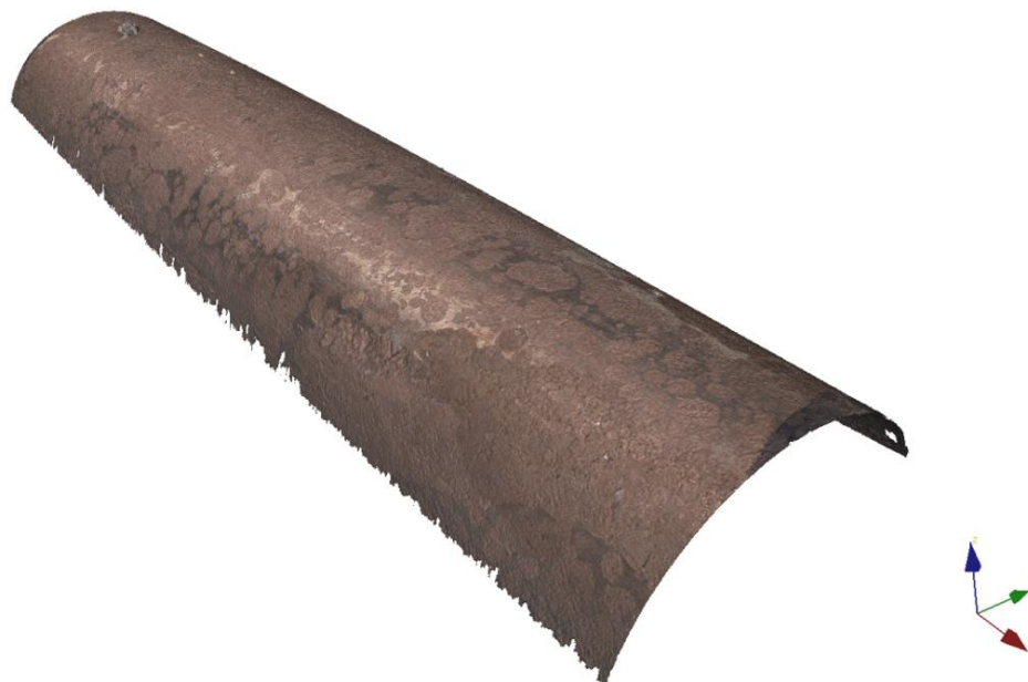
Figur 63: Prov 1 – inre kardel. Gropdjup 1-2 mikrometer.
