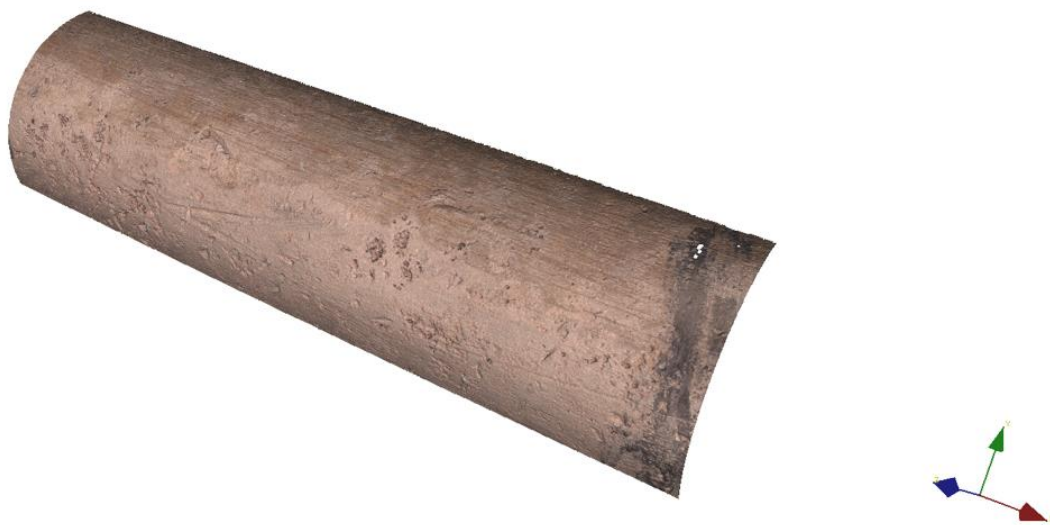
Figur 82: Prov 7 – Yttre karded (del 1). Gropdjup 48 mikrometer.
