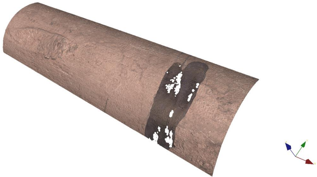
Figur 75: Prov 5 – Inre kandel. Gropdjup 1-2 mikrometer.
