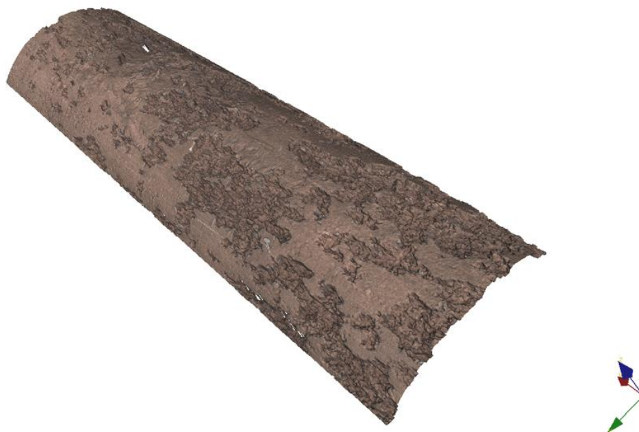
Figur 96: Prov 12 – Yttre kardel (del 2). Groddjup 134 mikrometer.
