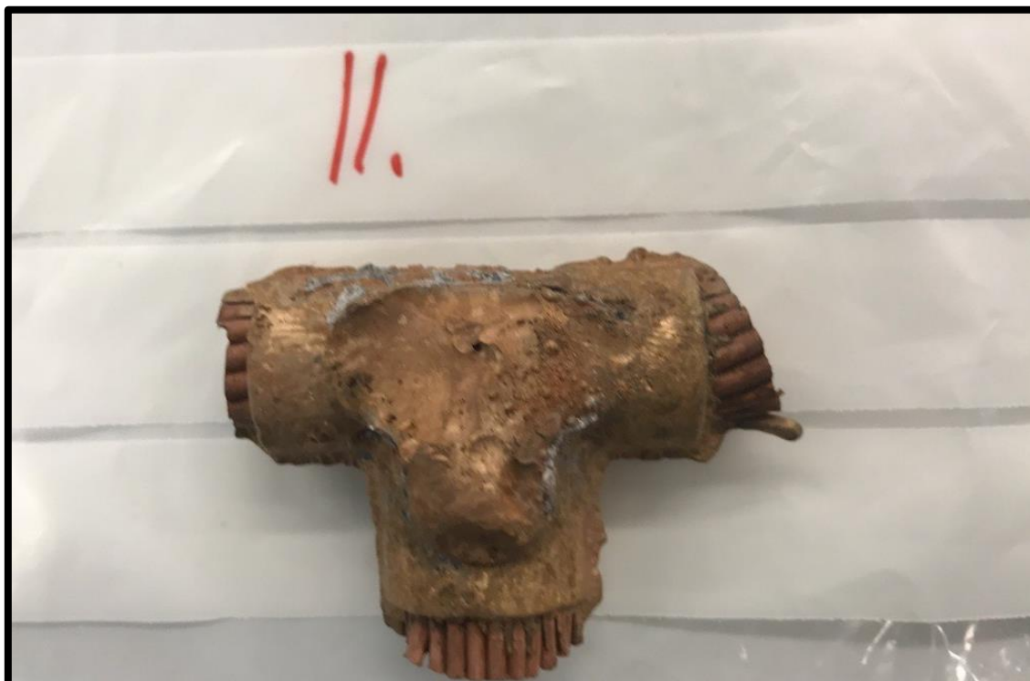
Figur 59: Klämma från prov 11 efter betning, baksida.
