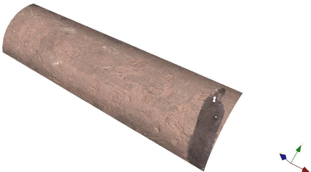
Figur 79: Prov 6 – Yttre kardel (del 1). Gropdjup 38 mikrometer.
