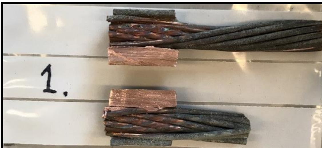
Figur 31: Prov 1, kapad klämma med kardeler. Till utseendet mindre påverkad av korrosion.
