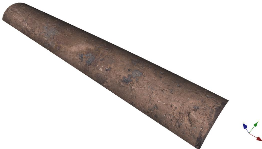
Figur 71: Prov 2 – Yttre kardel (del 2). Gropdjup 82 mikrometer.
