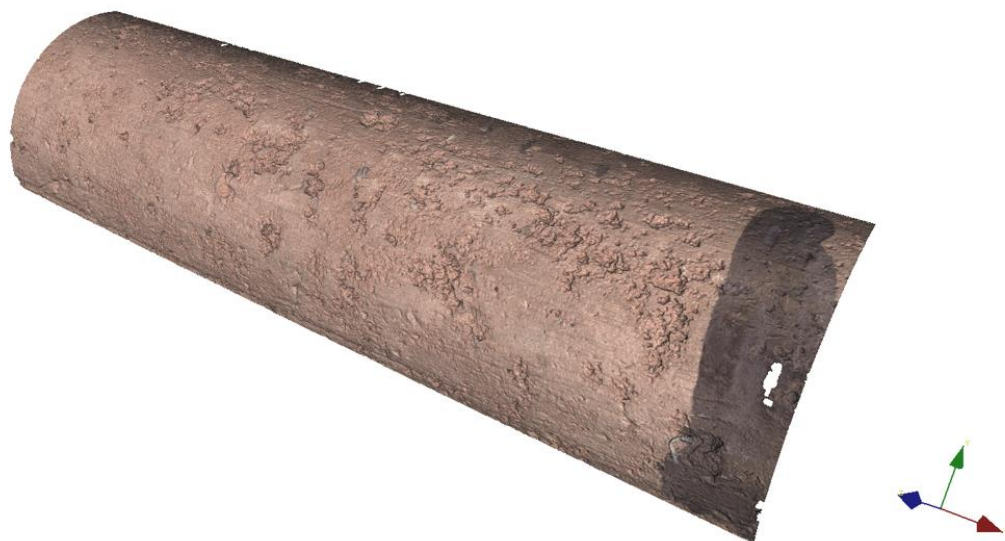
Figur 83: Prov 7 – Yttre kardel (del 2). Groppdjup 53 mikrometer.
