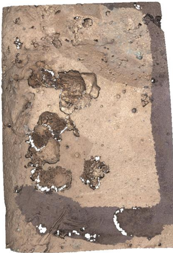
Figur 91: Prov 11 – Klämma. Gropdjup 407 mikrometer.
