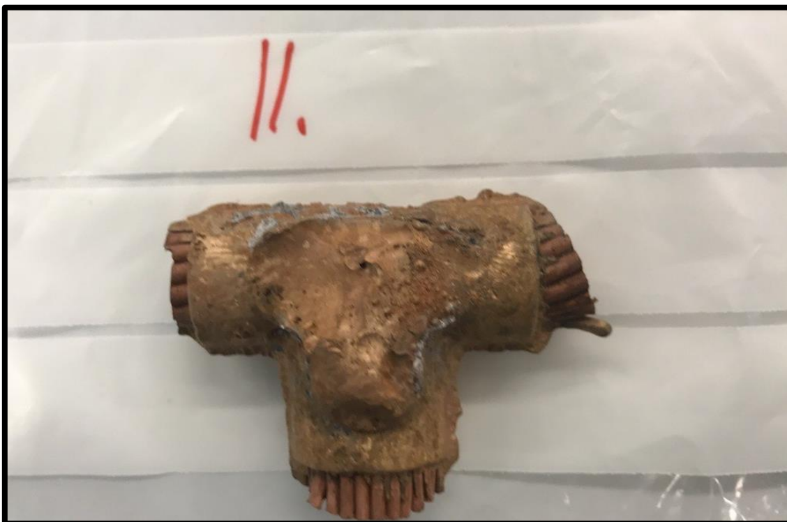
Figur 59: Klämma från prov 11 efter betning, baksida.
