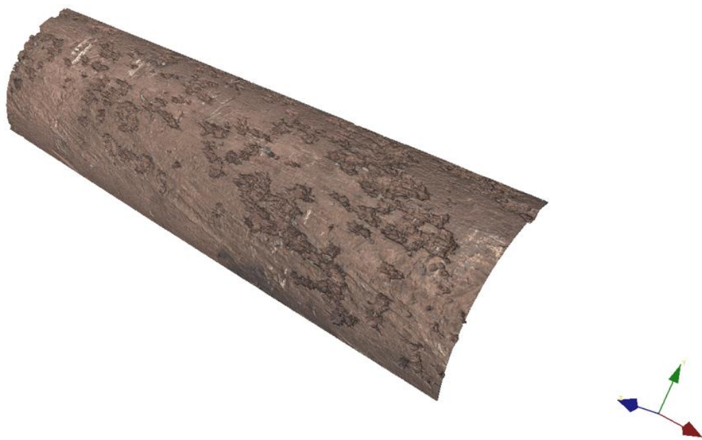
Figur 95: Prov 12 – Yttre kardel (del 1). Groddjup 113 mikrometer.
