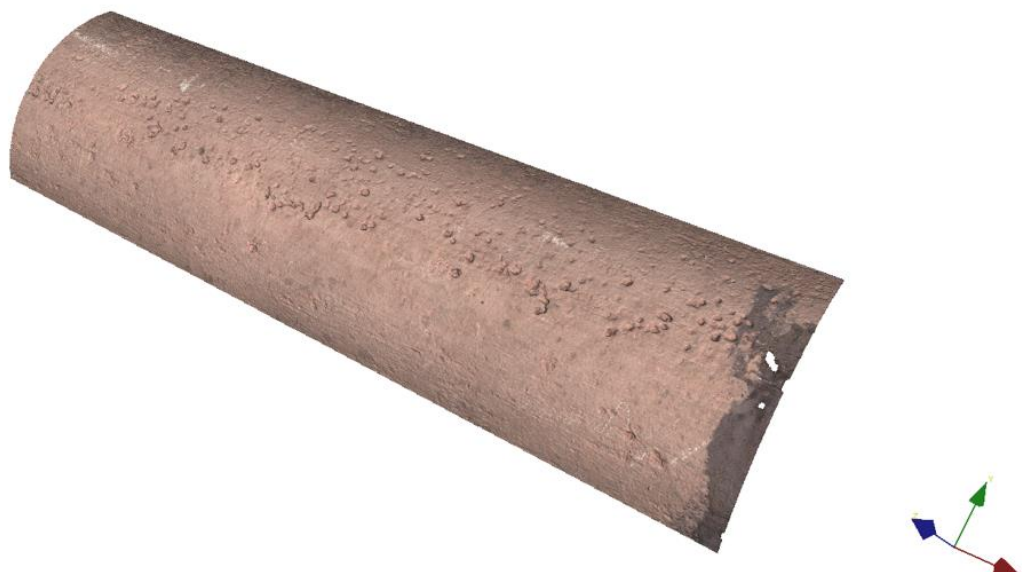
Figur 85: Prov 8 – Yttre kardel (del 1). Gropdjup 32 mikrometer.
