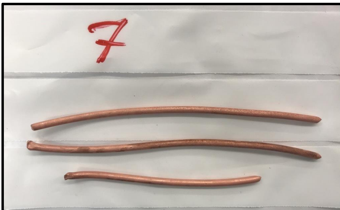
Figur 54: Kardeler från prov 7 efter betning.
