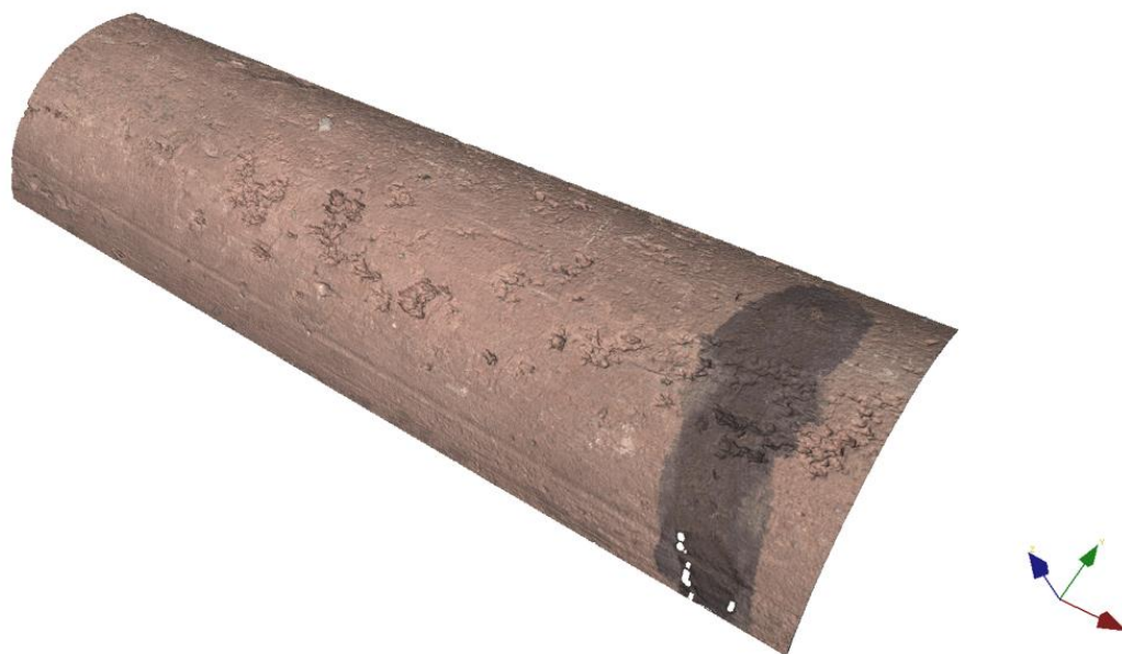
Figur 86: Prov 8 – Yttre kardel (del 2). Gropdjup 67 mikrometer.
