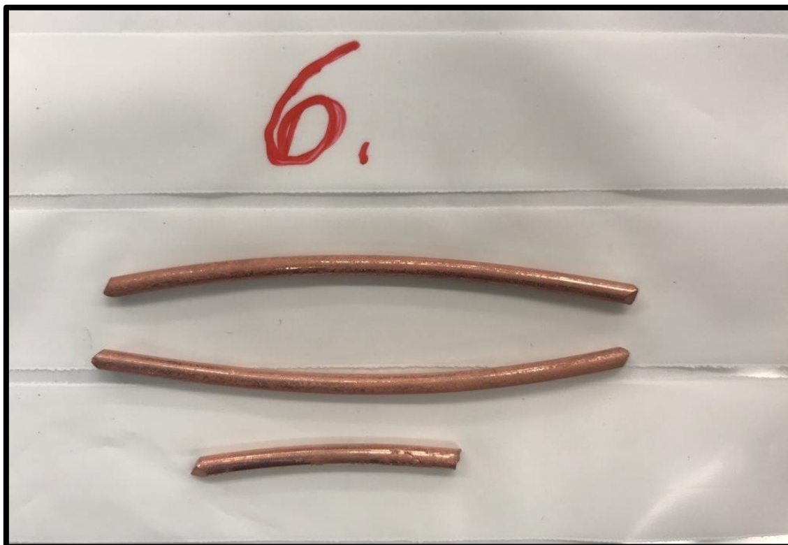
Figur 53: Kardeler från prov 6 efter betning.
