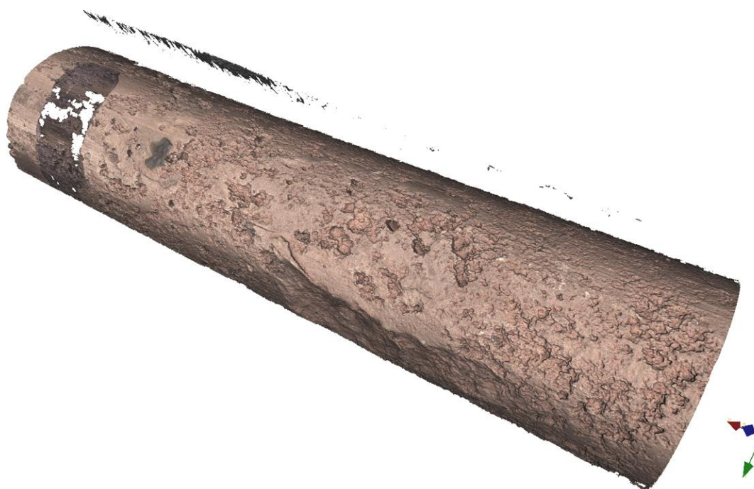
Figur 92: Prov 11 – Yttre kardel (del 1). Gropdjup 121 mikrometer.
