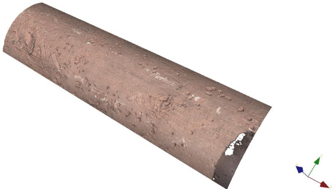
Figur 76: Prov 5 – Yttre kandel (del 1). Gropdjup 55 mikrometer.
