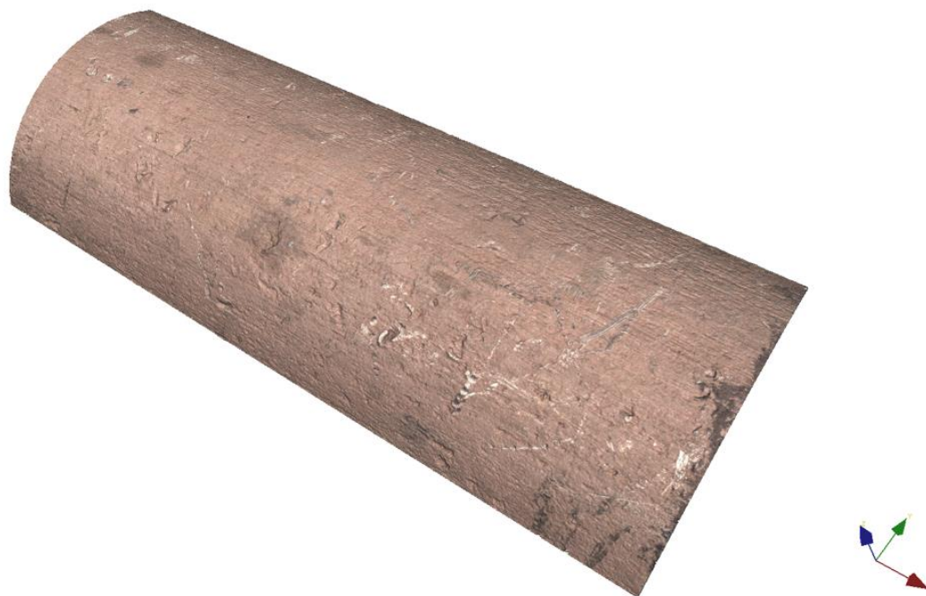
Figur 93: Prov 11 – Yttre kardel (del 2). Groddjup 1-2 mikrometer.
