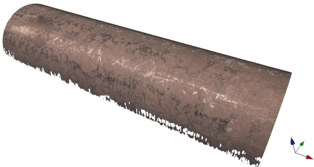
Figur 66: Prov 1 – Yttre kardel (del 1). Gropdjup 1-2 mikrometer.
