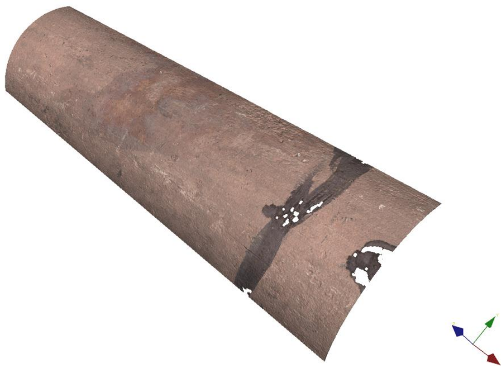
Figur 73: Prov 4 – Yttre kardel (del 1). Gropdjup 16 mikrometer.
