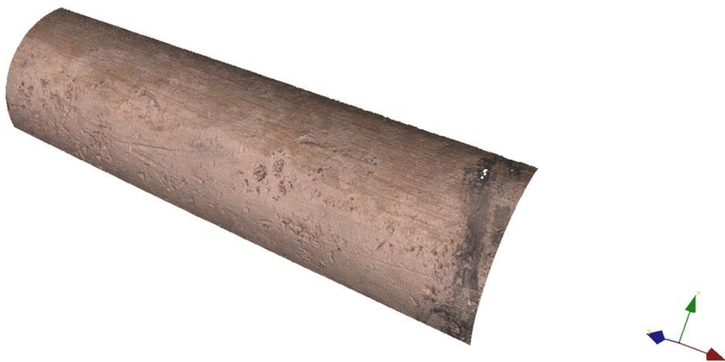
Figur 82: Prov 7 – Yttre karded (del 1). Gropdjup 48 mikrometer.
