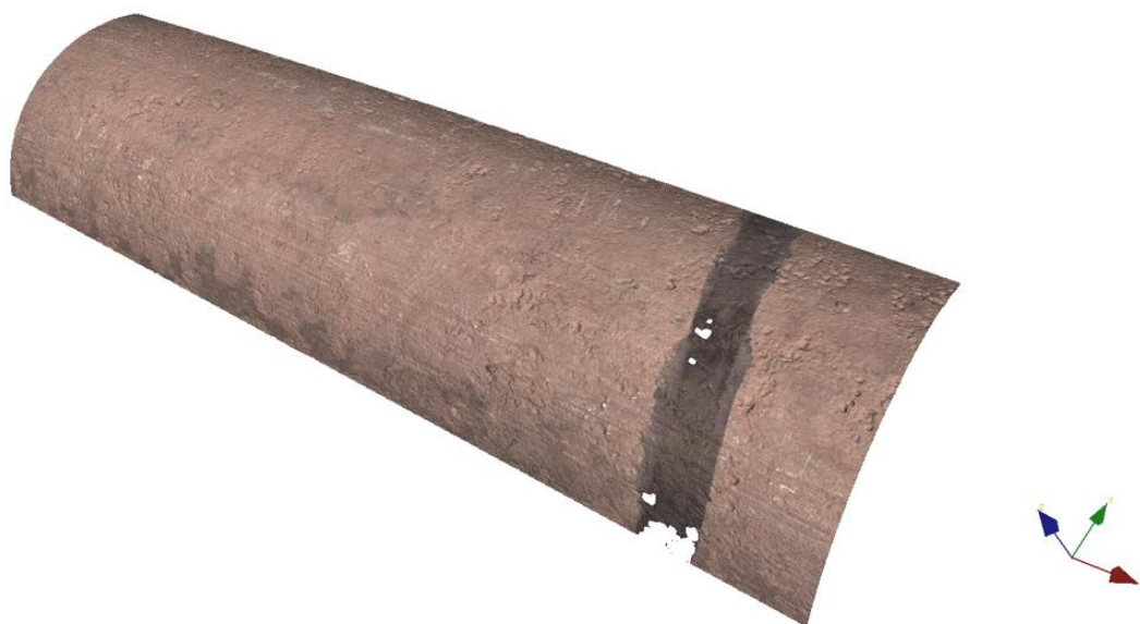
Figur 74: Prov 4 – Yttre kardel (del 2). Gropdjup 23 mikrometer.
