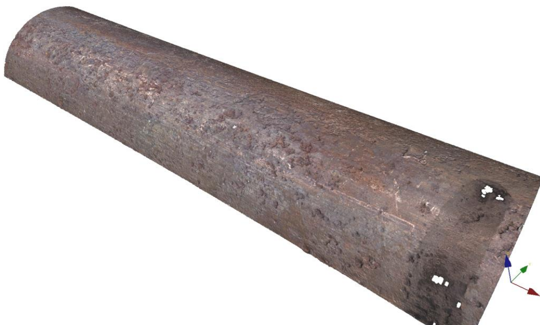
Figur 67: Prov 1 – Yttre karded (del 2). Grotdjup 44 mikrometer.
