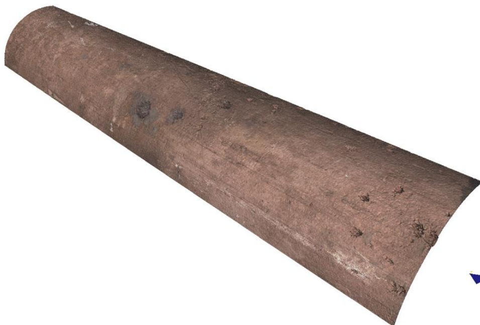
Figur 70: Prov 2 – Yttre kardel (del 1). Gropdjup 141 mikrometer.
