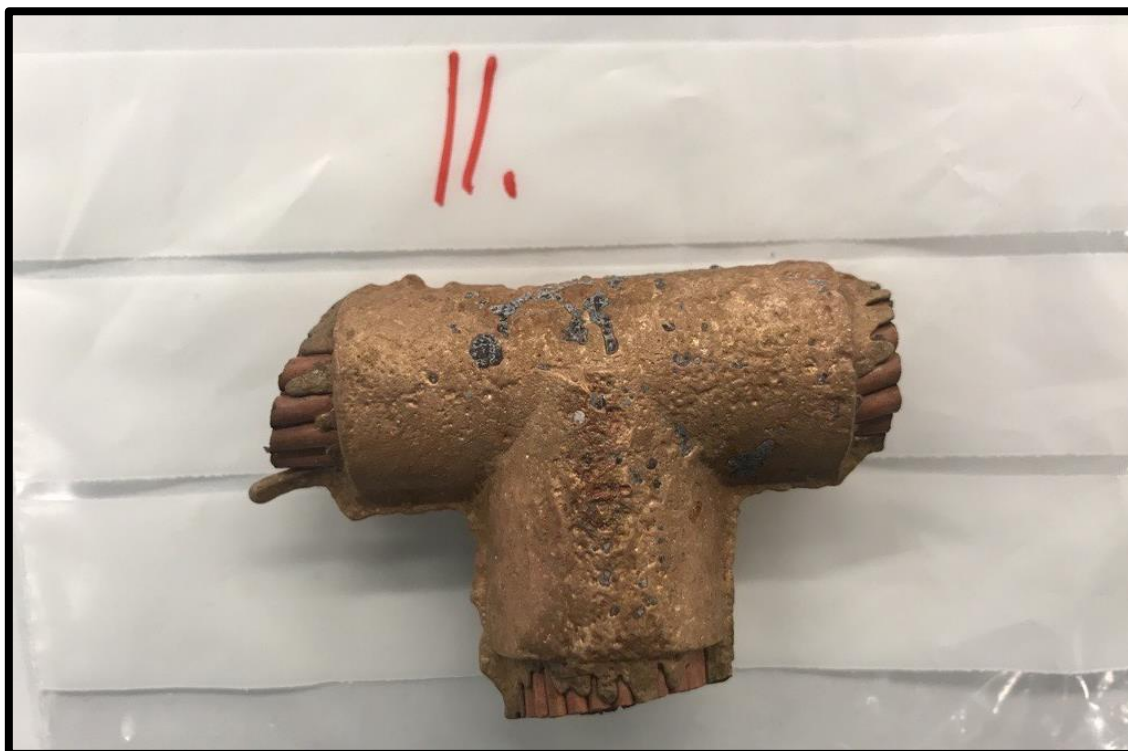
Figur 58: Klämma från prov 11 efter betning, framsida.
