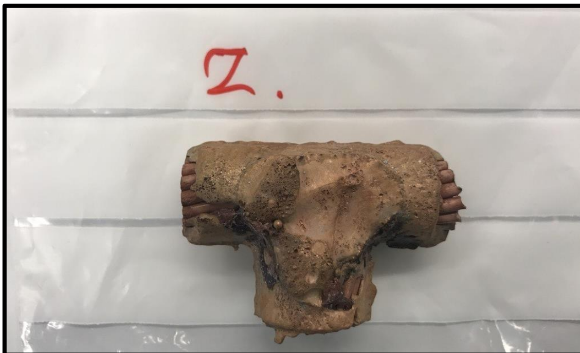
Figur 50: Klämma från prov 2 efter betning, baksida.
