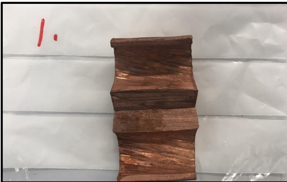
Figur 46: Klämma från prov 1 efter betning, insida.
