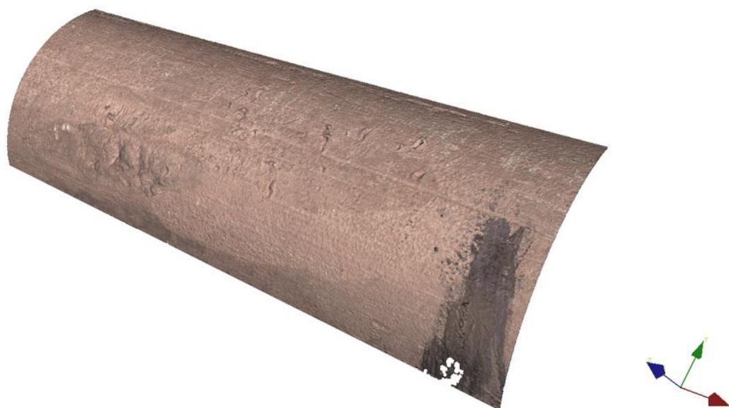
Figur 77: Prov 5 – Yttre kardel (del 2). Gropdjup 1-2 mikrometer.
