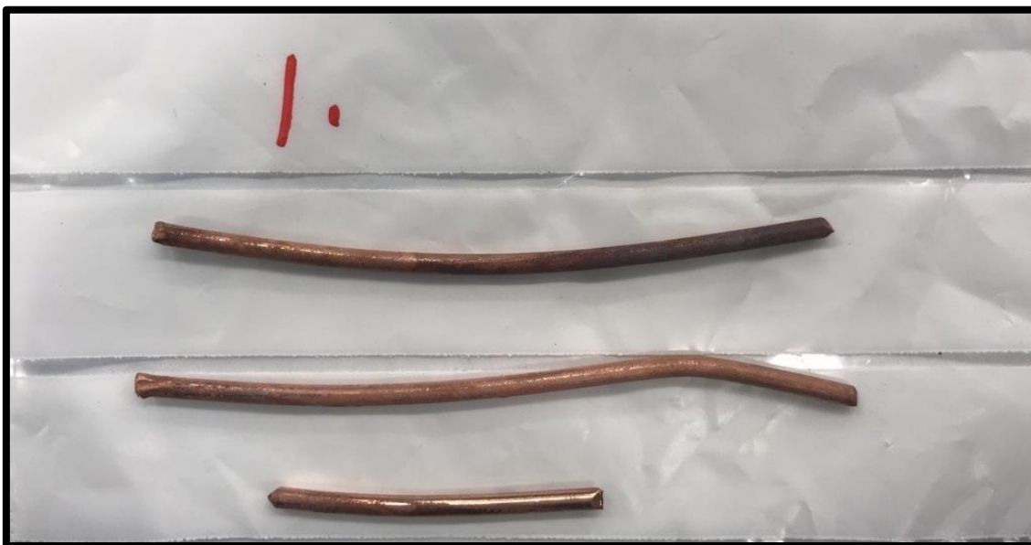
Figur 45: Kardeler från prov 1 efter betning.
