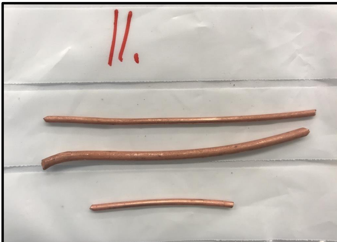
Figur 57: Kardeler från prov 11 efter betning.
