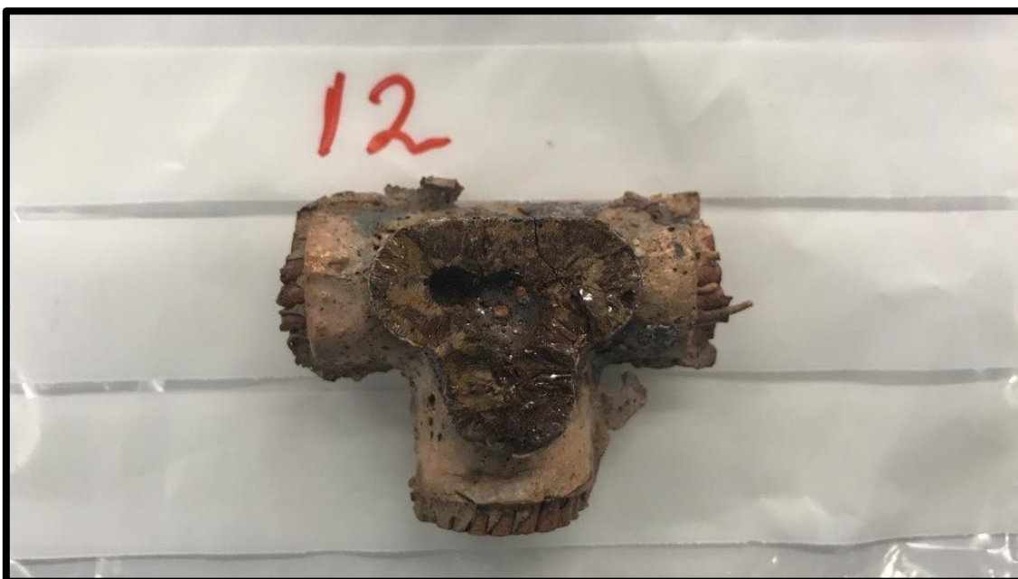
Figur 62: Klämma från prov 12 efter betning, baksida.
