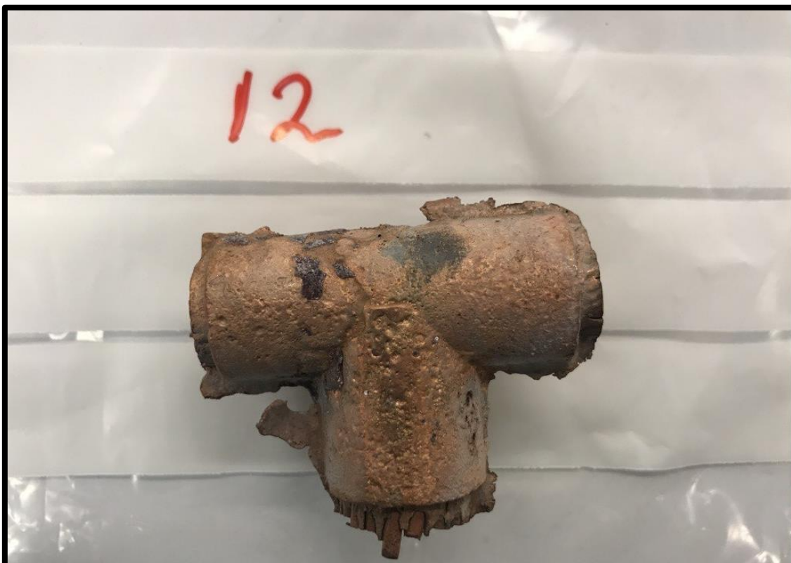
Figur 61: Klämma från prov 12 efter betning, framsida.
