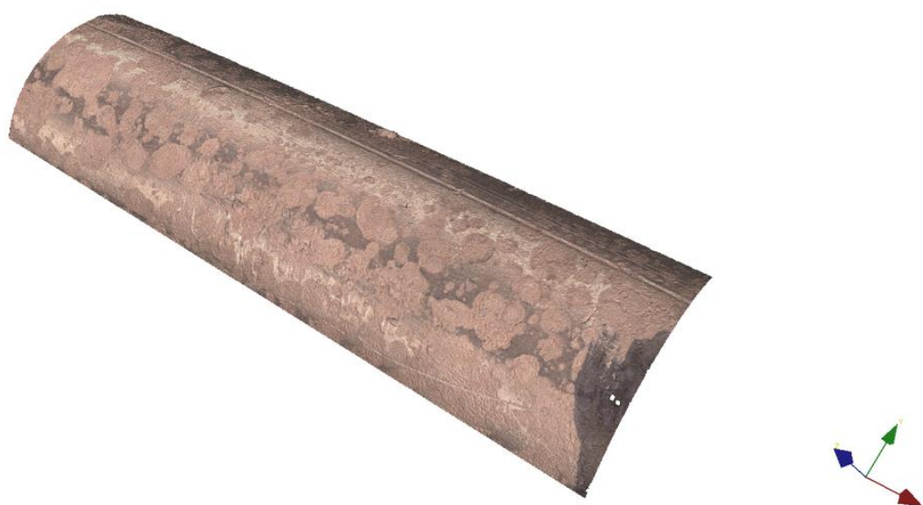
Figur 78: Prov 6 – Inre kardel. Gropdjup 1-2 mikrometer.
