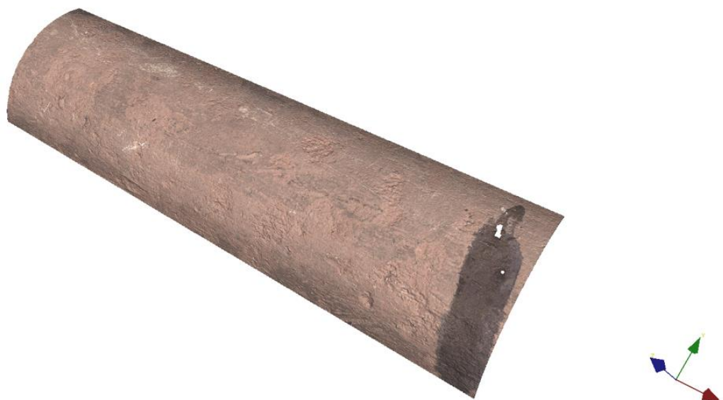
Figur 79: Prov 6 – Yttre kardel (del 1). Gropdjup 38 mikrometer.
