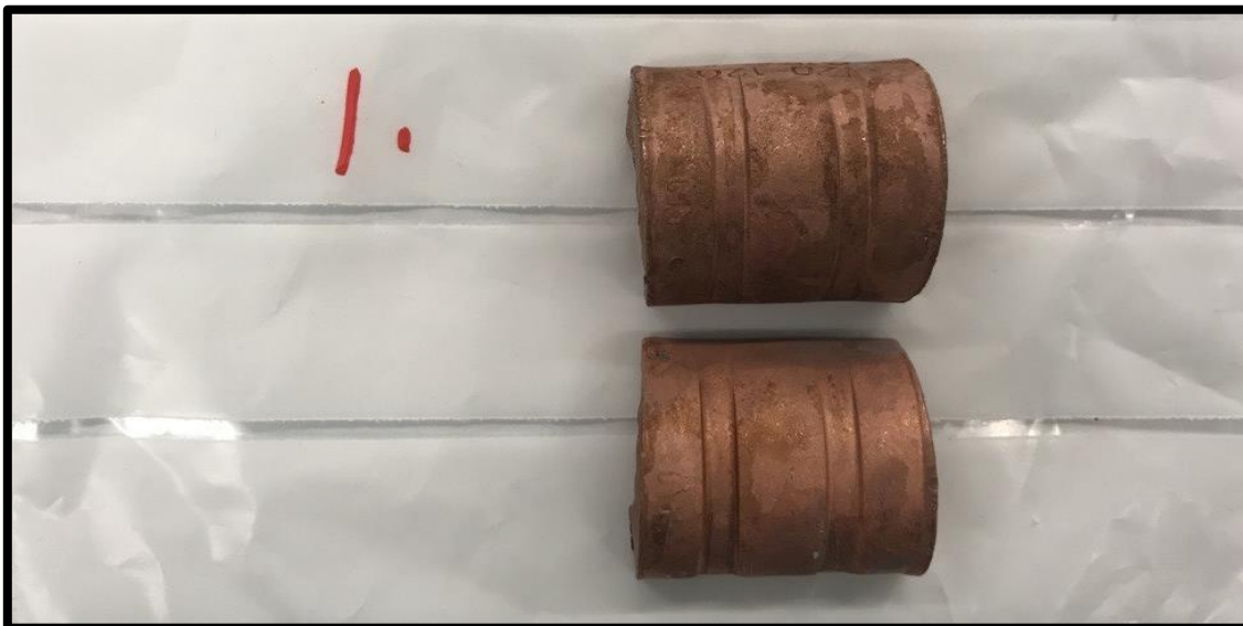
Figur 47: Klämman från prov 1 efter betning, utsida.
