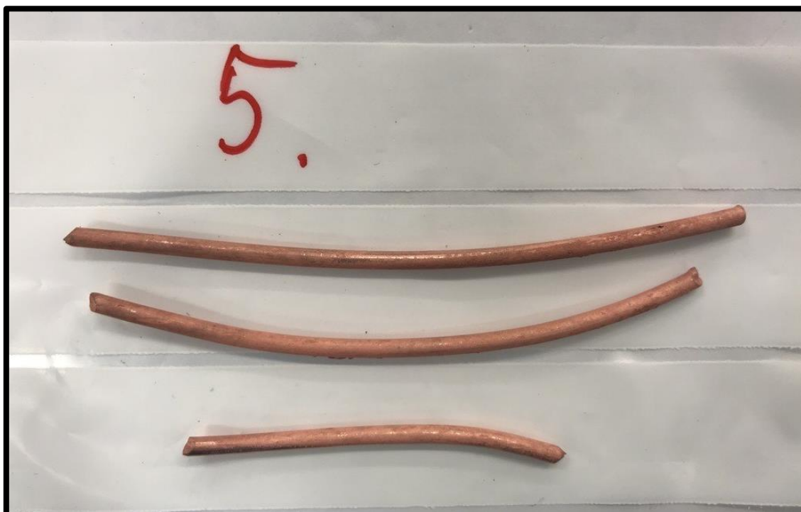
Figur 52: Kardeler från prov 5 efter betning.
