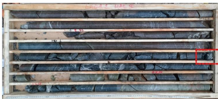
Figur 6 Lerfylld spricka observerad i borrkärna från kärnborrhål nr. 4 (markerat i rött) [13].
