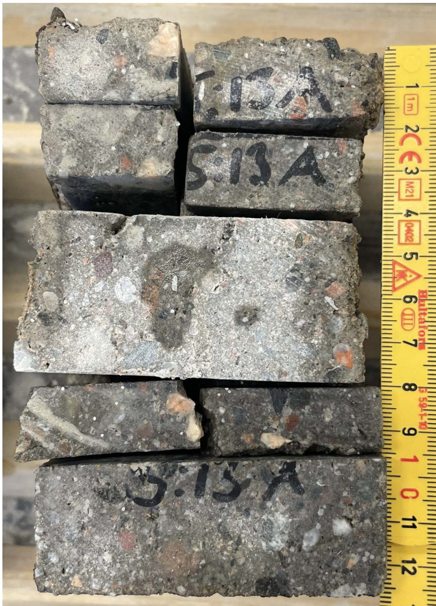
Bild 3. Prov "5:13A" efter sågning av bitar som användes för tillverkning av tunnslip och för analys i SEM.
