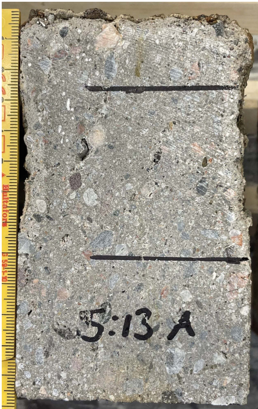
Bild 2. Prov "5:13A". Linjer markerar områden som analyserades i tunnslip.
