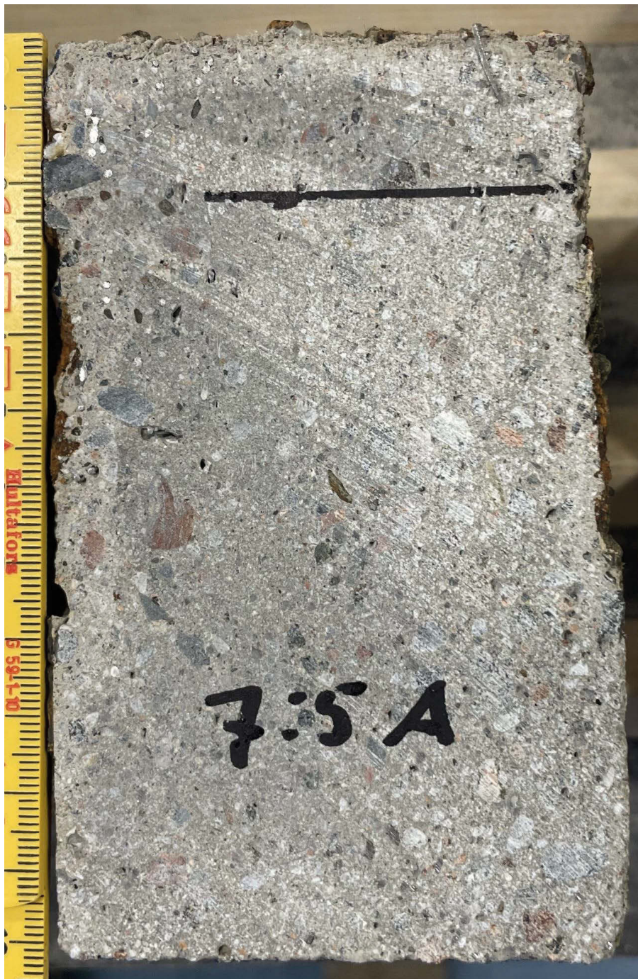
Bild 4. Prov "7:5A". Linje markerar område som analyserades i tunnslip.
