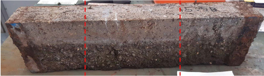
Figur 2. Läge för mätning av erosionsgrad (röda streck).
