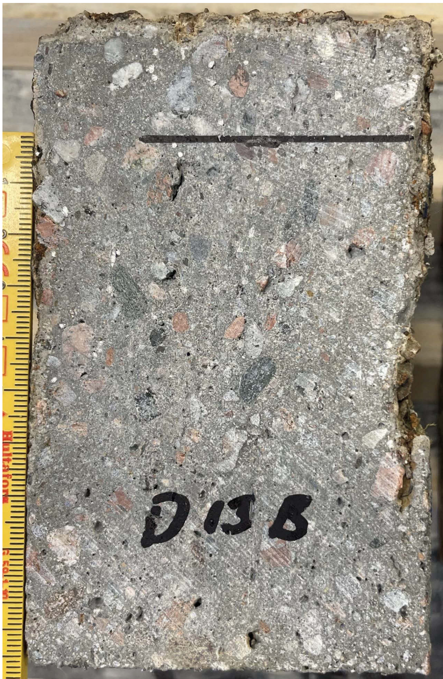
Bild 6. Prov "D:13B". Linje markerar område som analyserades i tunnslip.
