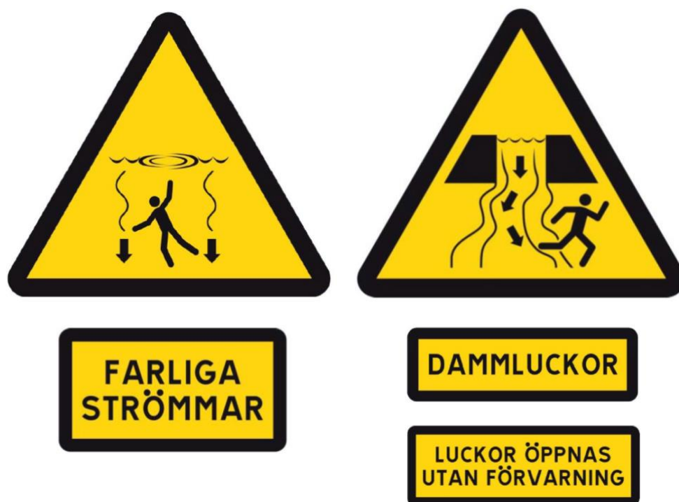
Figur 4. Exempel på varningsskyltar utformade enligt den standard som Energiföretagen har utarbetat. I figuren visas exempel på både piktogram (trekantiga skyltar) och tilläggs-skyltar med text.
