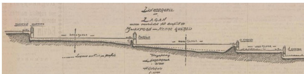
Figur 24. Profilregleringen innebar att laxens lekområden och habitat för smolt överdämades och försvann. Här syns profilregleringen vid Lagans kraftverk från år 1908 vars laxtrappor nedmonterades år 1923 90 .
