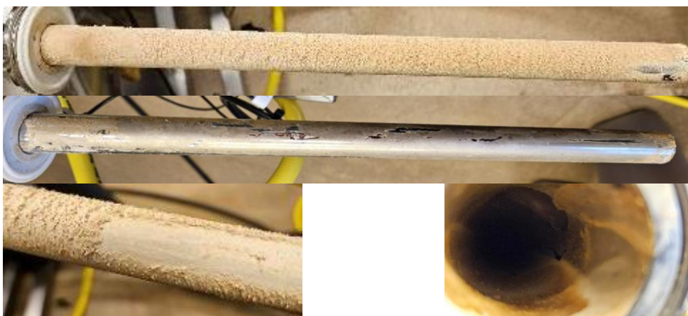
Figur 8. Typiskt utseende på inkruster från experimenten, i detta fall B-Ref. Huvuddelen av inkrusterna var på översidan av proben (övre bild), medan undersidan bara innehåll tunna fragment (mellersta bild). Typiskt bestod inkrusterna av två lager, ett inre tunnare och finare samt ett grövre, porösare och lösare yttre lager (nedre bild till vänster). Det fanns också betydande mängder inkruster på manteln runt proben (nedre bild till höger).
