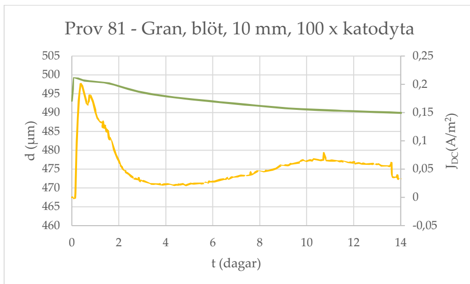
Figur 22: Prov 81 - Gran, blöt, 10 mm, 100 x katodyta, visar dimension ( d , grön kurva) och strömdensitet ( J , gul kurva).
