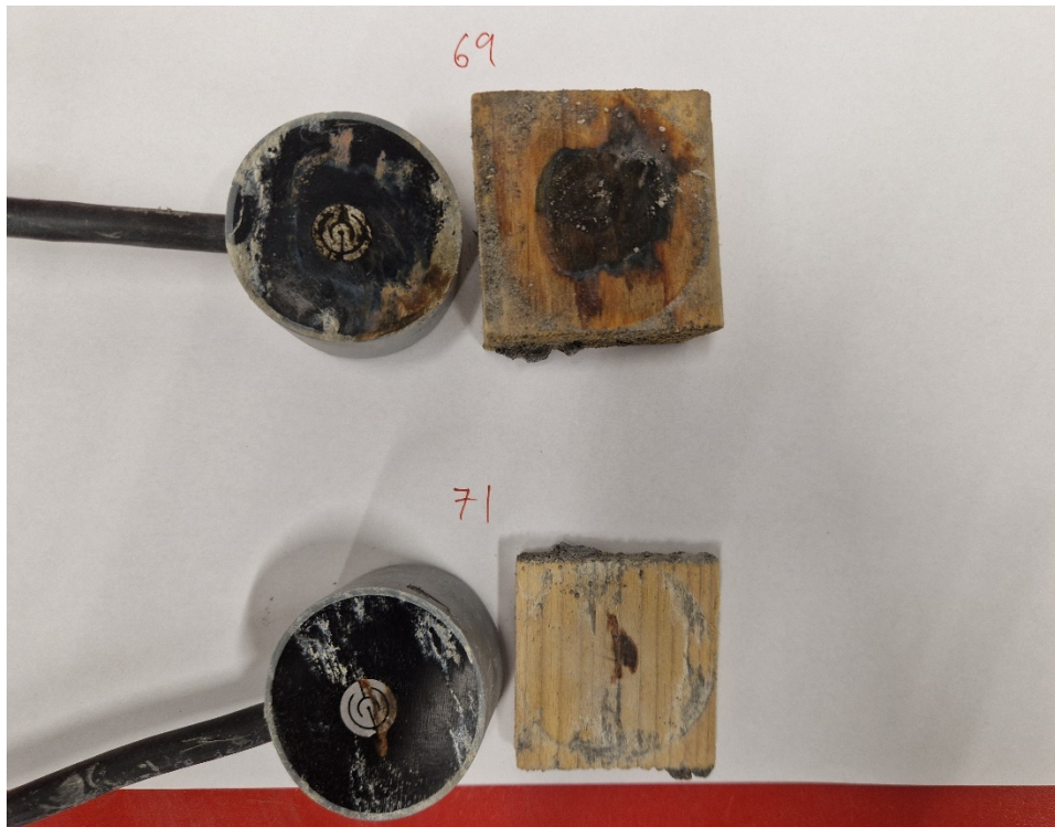
Figur 26: Visuellt inspektion av ER-prob från försök 69 och försök 71.
