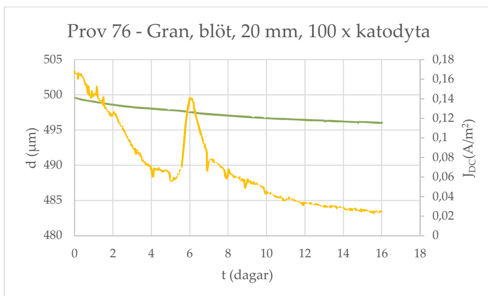
Figur 18: Prov 76 - Gran, blöt, 20 mm, 100 x katodyta, visar dimension ( d , grön kurva) och strömdensitet ( J , gul kurva).
