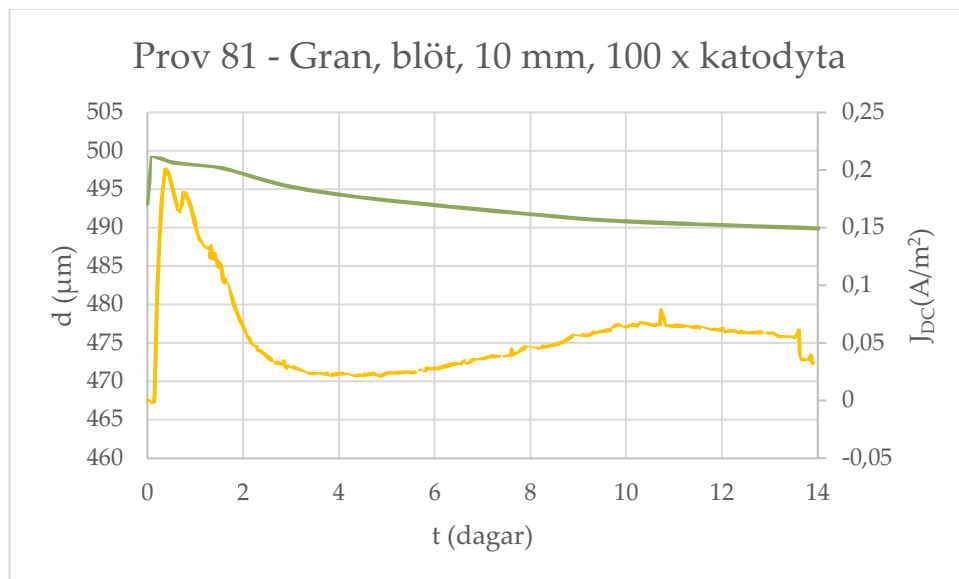
Figur 33: Prov 81 - Gran, blöt, 10 mm, 100 x katodyta, visar dimension (d, grön kurva) och strömdensitet (J, gul kurva). (Samma figur som i Figur 22).
